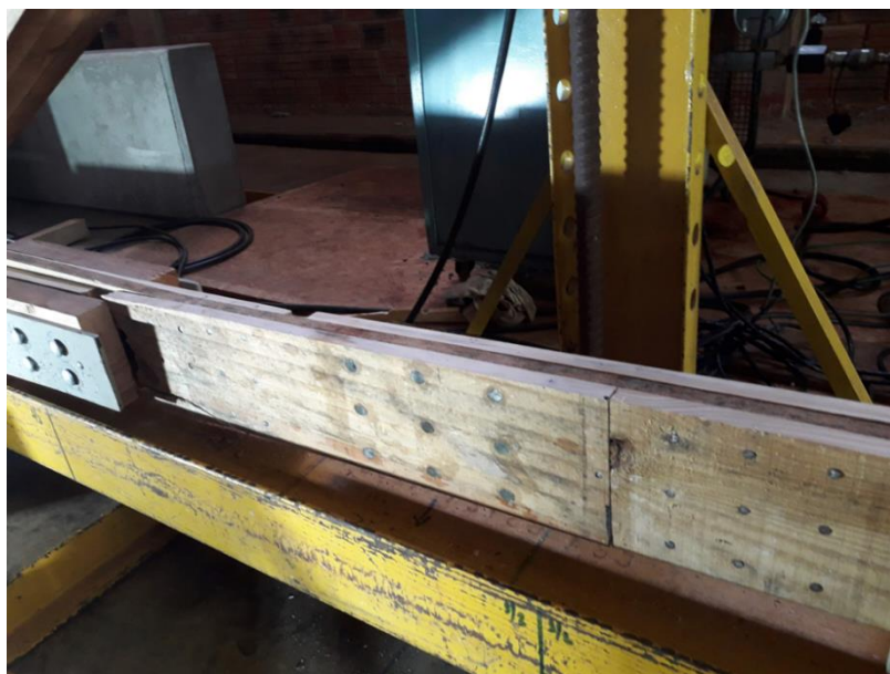
Figura 3.2 - Ligação cavilhada com cavilhas de polímero reforçado com fibra de vidro.
