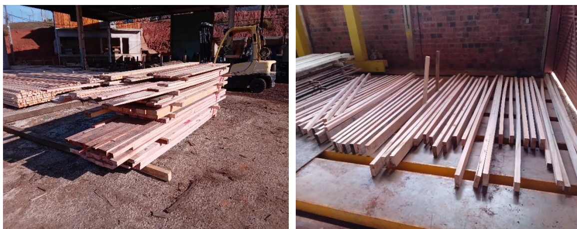
Figura 4.2 - Madeira utilizada na pesquisa Pinus taeda e Eucalyptus saligna : (a) Etapa de corte das peças; (b) Armazenada no laboratório de estruturas UEL
