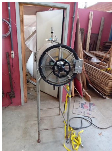
Figura 4.14 - Equipamento de pressão para realização da impregnação: (a) Vista lateral; (b) Vista frontal
