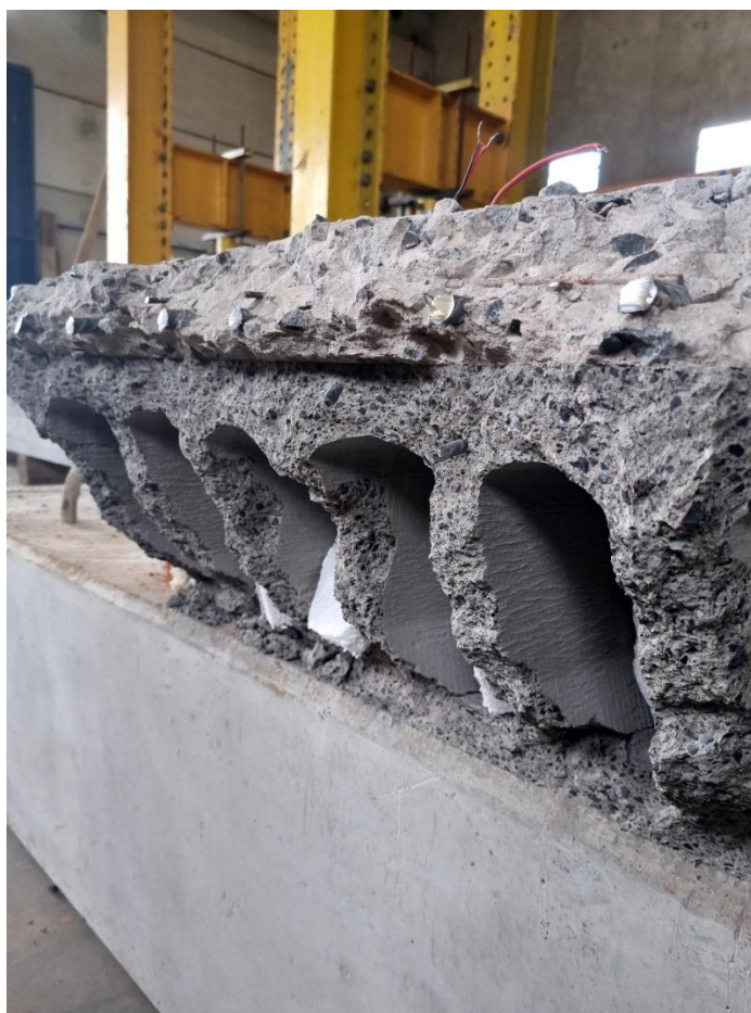
Figura 100: Aderência entre concreto da laje e da capa e situação do concreto nas nervuras
