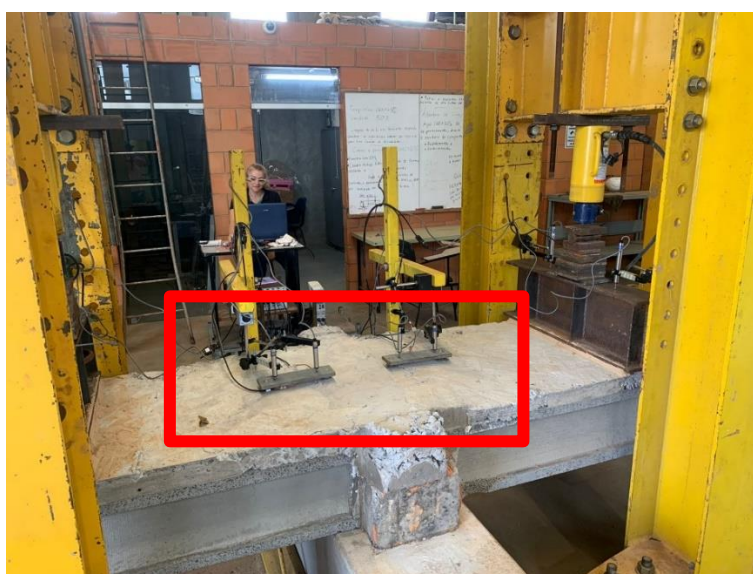
Figura 65: Travamento da viga de apoio central na laje de reação
