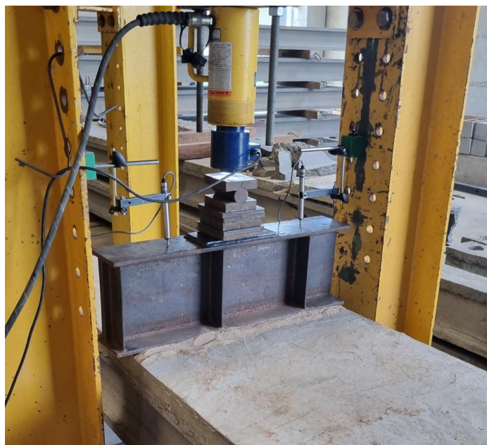
Figura 55: Arranjos para ensaio de lajes ao cisalhamento
