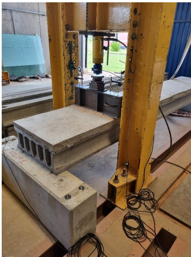
Figura 74: Ensaio de cisalhamento em laje alveolar com capa
