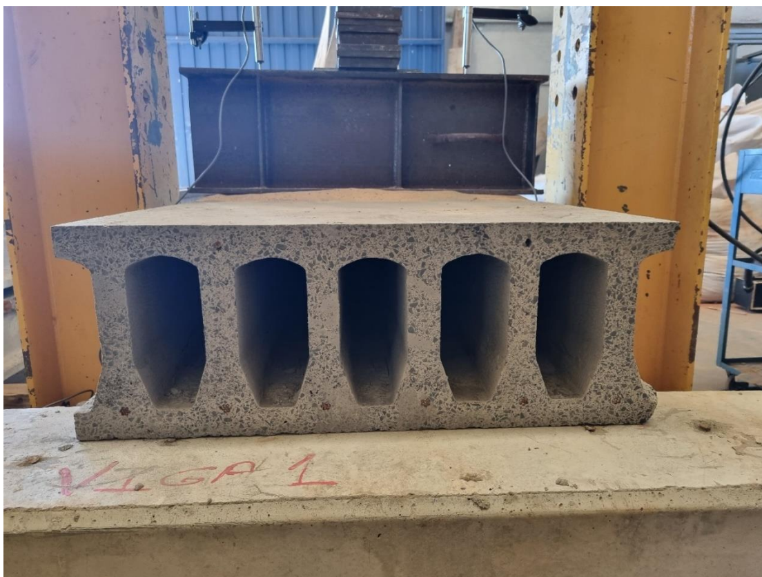
Figura 66: Ensaio de cisalhamento em laje alveolar
