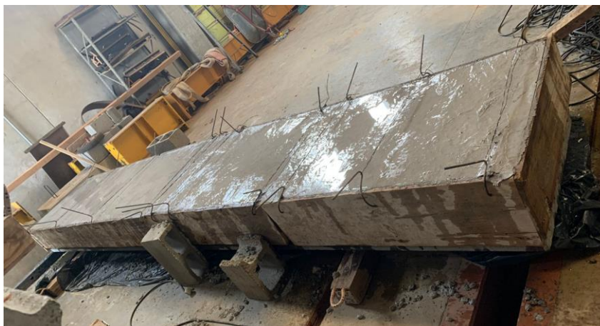
Figura 58: Processo de cura da laje alveolar com capa
