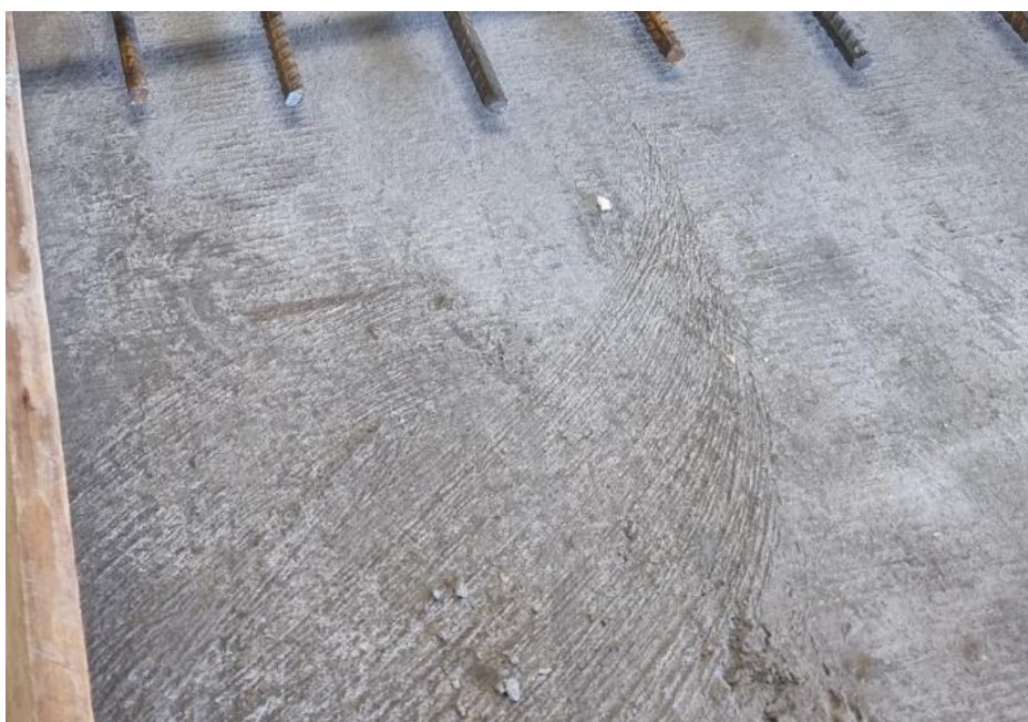
Figura 78: Rugosidade da superfície superior da laje ensaiada
