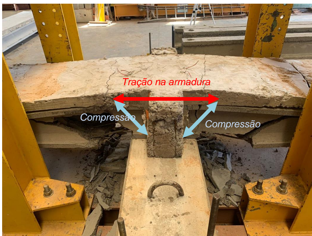
Figura 107: Mecanismo secundário – laje com capa e continuidade
