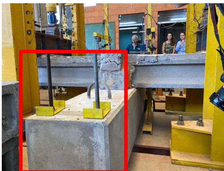
Figura 64: Travamento da viga de apoio central na laje de reação
