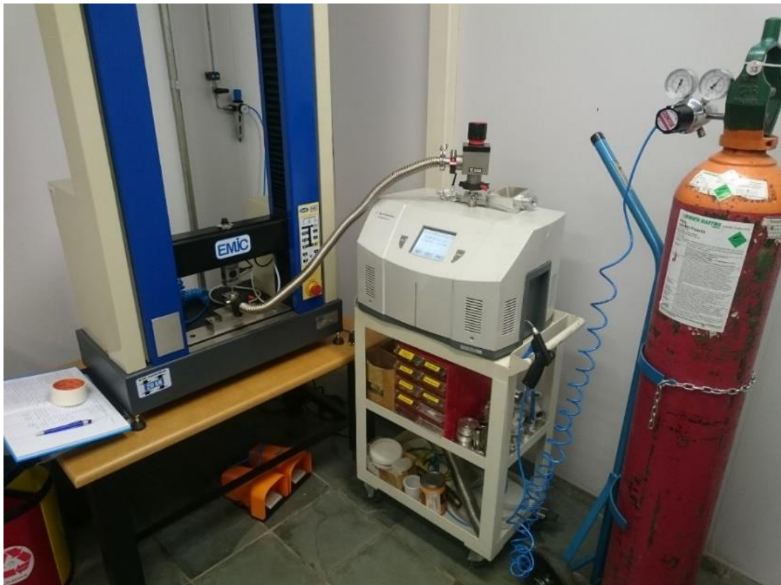
Figura 3.10 – Esquema geral de montagem do ensaio de estanqueidade em vácuo para determinar as propriedades mecânicas do BPM brasado, evidenciando a máquina universal de ensaios, o detector de vazamentos e cilindro de He utilizado no ensaio (Fonte: LNLS).
