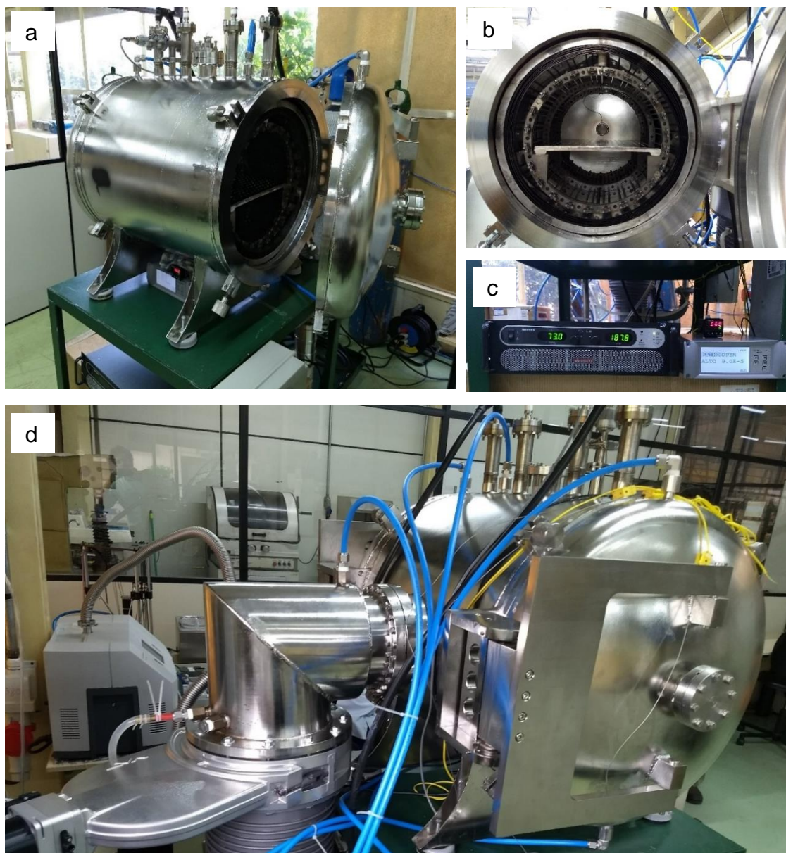
Figura 3.5 – Forno de brasagem construído e seus subsistemas: a) vista geral do equipamento mostrando a câmara em aço inoxidável, (b) interior da câmara indicando a mesa de trabalho e as resistências de aquecimento, (c) sistemas de controle e fonte de potência e (d) bombas de vácuo mecânica e difusora.
