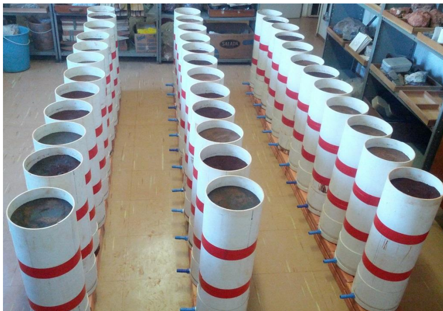
Figura 6. Vista geral do experimento, delineamento inteiramente casualizado em parcelas subdivididas das colunas de Latossolo e Neossolo, após a aplicação dos tratamentos (vinhaça ou água destilada).
