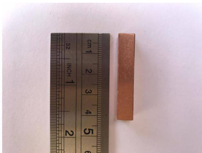
Figura 4.1 - Tarugo de cobre usinado para o processo de ECA-T.
