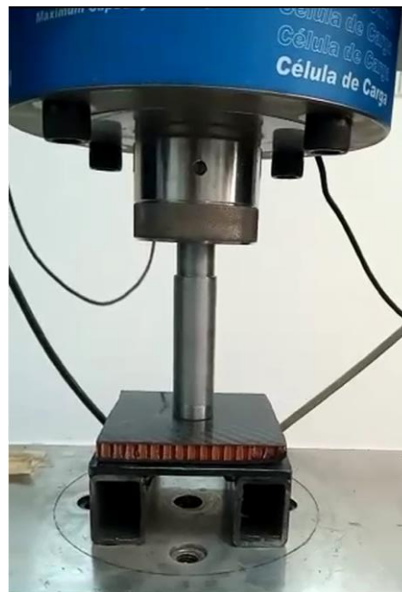
FIGURA 19 – Fotografia do ensaio de cisalhamento perimetral
