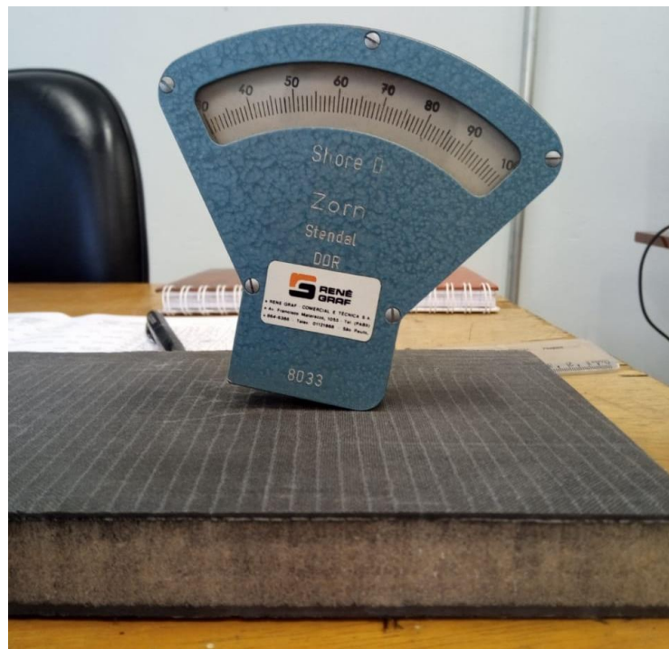
FIGURA 21 – Medição com Durômetro Shore D
