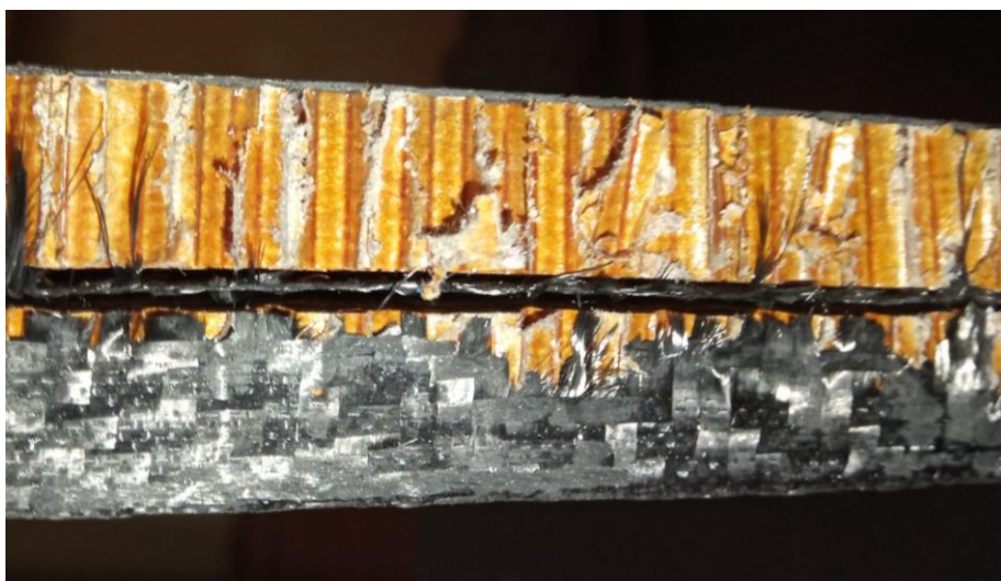
FIGURA 31 – Imagem da Região Fraturada da Amostra Layup 3
