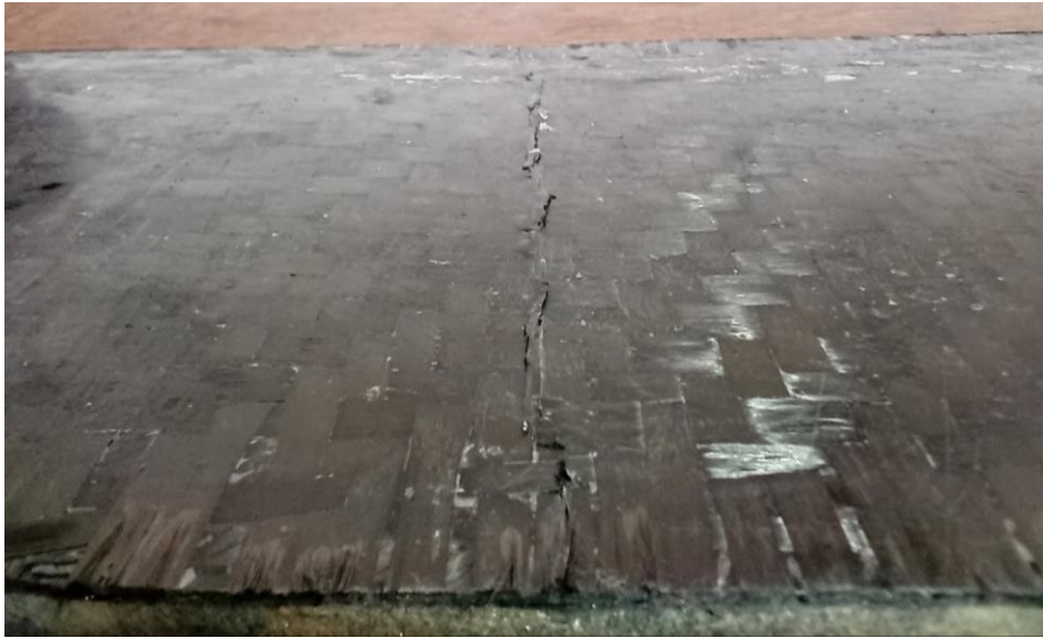
FIGURA 41 – Imagem da fratura da amostra Layup 6
