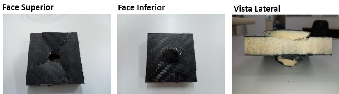
FIGURA 53 – Fotografias da amostra Layup 5 fraturada
