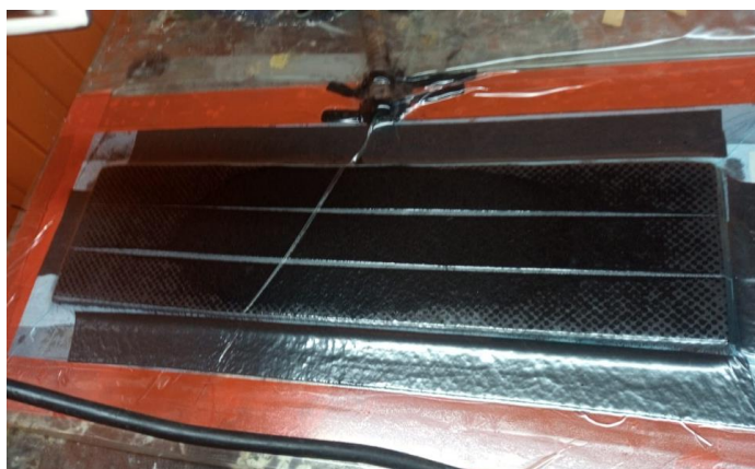
FIGURA 11 – Fotografia do processo de laminação por bolsa de vácuo ( vaccum bag ).
