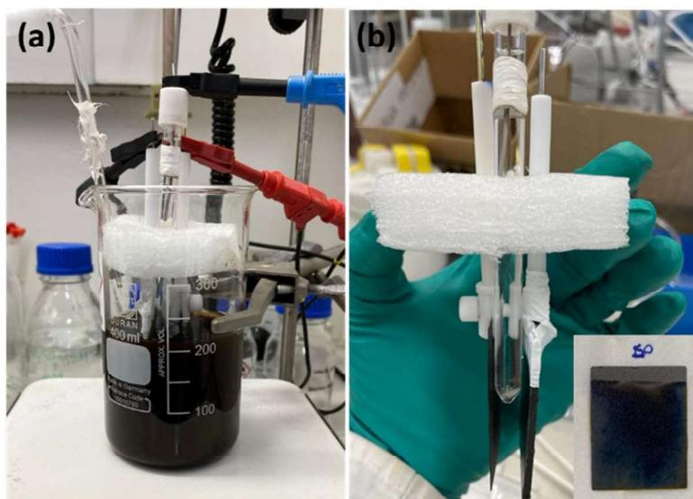
Figura 2.2: (a) Célula eletroquímica adaptada para preparar o cátodo  $\text{MoS}_x/\text{PC}$  com  $17,64 \text{ cm}^2$ . (b) Tampa da célula eletroquímica adaptada com os eletrodos de trabalho, auxiliar (placa de grafite), e referência (Ag/AgCl). *Inset*: eletrodo
