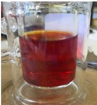
Figura 3.1: Solução precursora de (NH<sub>4</sub>)<sub>2</sub>MoS<sub>4</sub> em eletrólito de NaClO<sub>4</sub> para preparação dos filmes de MoS<sub>x</sub> pela técnica da eletrodeposição.
