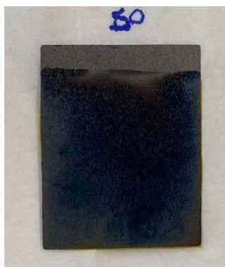
Figura 3.48: Cátodo de MoS<sub>x</sub>/CP preparado por 50 ciclos em solução 10 mmol L<sup>-1</sup> (NH<sub>4</sub>)<sub>2</sub>MoS<sub>4</sub> com área ativa de 17,64 cm<sup>2</sup>.
