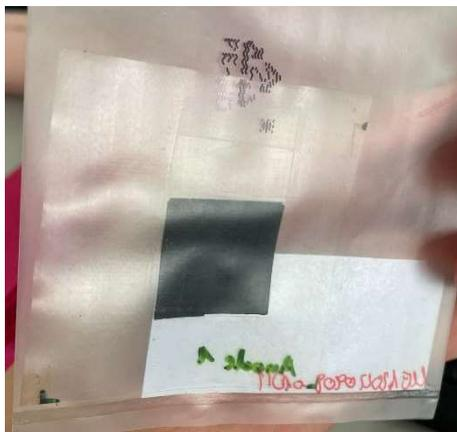
Figura 3.49: Membrana de Nafion com Ir depositado a  $2,1 \text{ mg cm}^{-2}$ .
