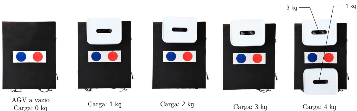
Figura 46 – Configurações de carga ensaiadas, com a localização das cargas na plataforma do AGV.
