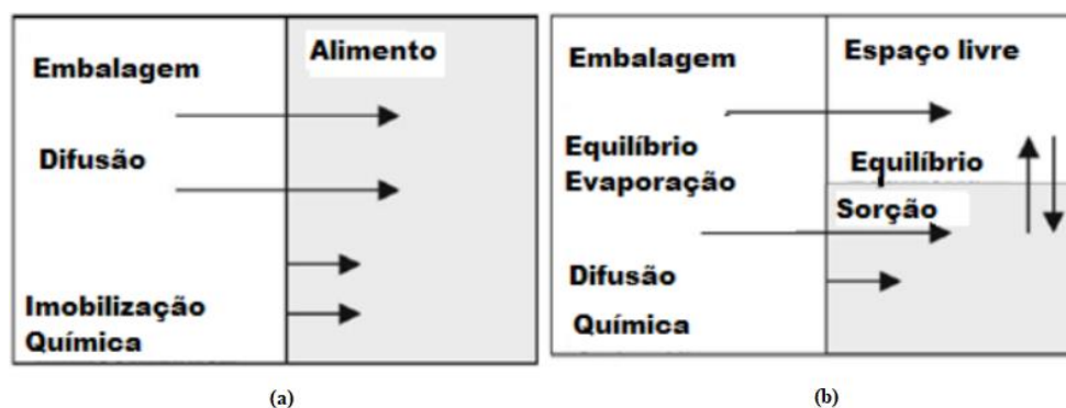
Figura 3: Sistemas de embalagens e comportamento de substâncias antimicrobianas; a) sem presença de espaço livre; b) com presença de espaço livre. Fonte: SAORIN (2015)
