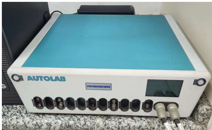
Figura 13 - Potenciostato Autolab PGSTAT302N utilizado para a realização dos ensaios eletroquímicos.
