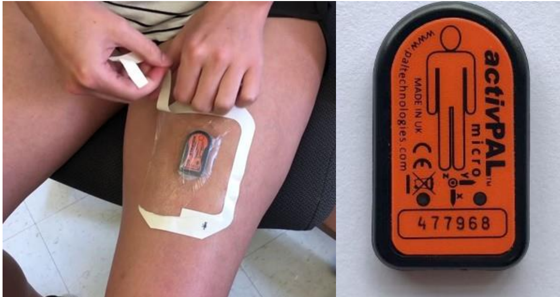
Figura 2. Actígrafo ActivPAL3™ micro e fixação no participante (PAL Technologies Ltd., Glasgow, Reino Unido)
