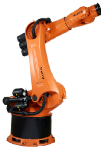
Figura 1 – Manipulador serial de cadeia aberta KUKA, modelo KR 240 R3330.
