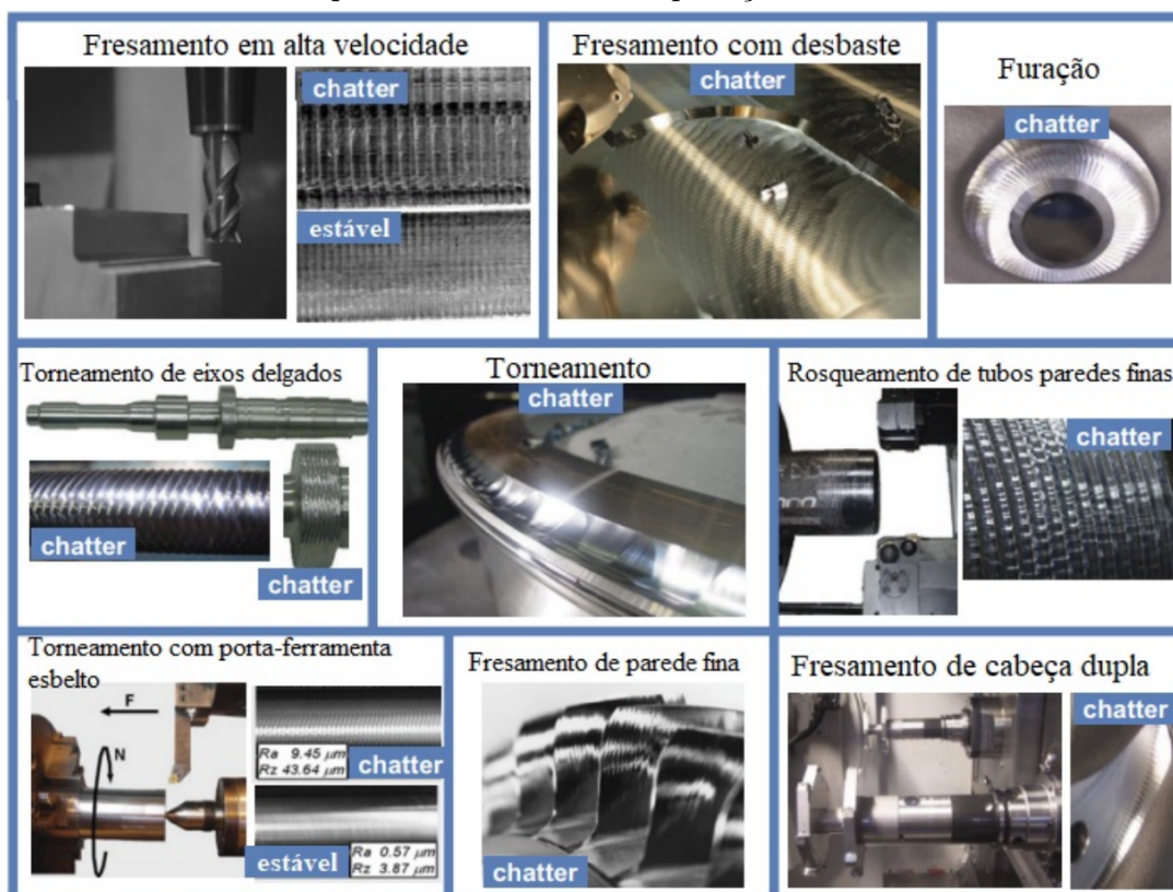
Figura 3 – Acabamento superficial de diferentes aplicação mediante ocorrência de chatter .
