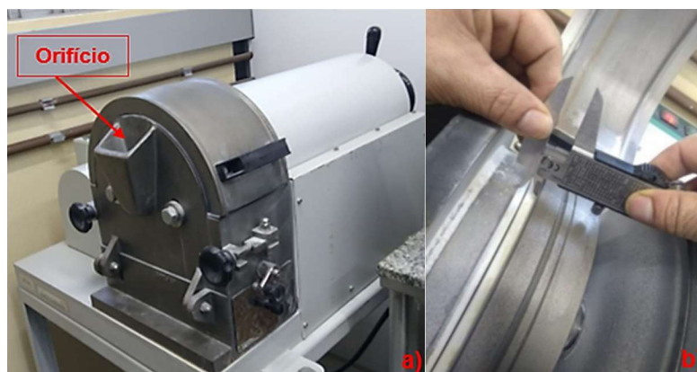
Figura 11 – Moagem dos grãos quartzo: (a) Moinho pulverizador; (b) Ajuste dos discos
