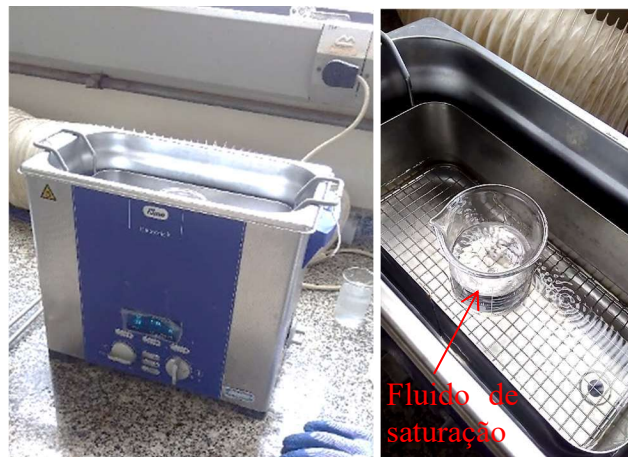
Figura 16 – Misturador ultrassônico: a) vista externa; b) vista interna
