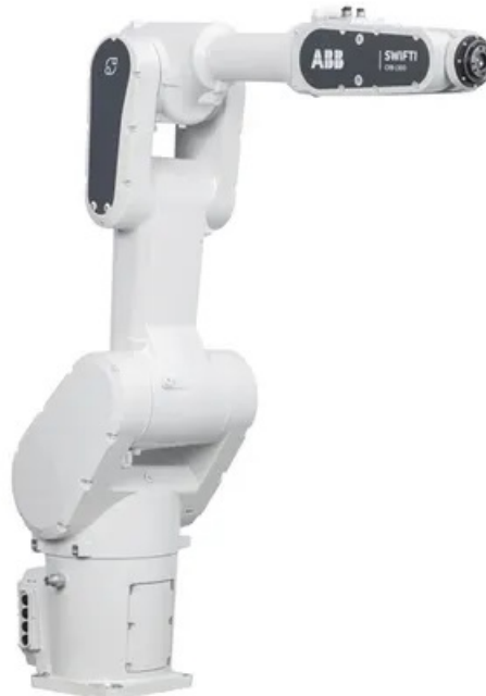
Figura 1 – Manipulador serial modelo ABB SWIFTI™ CRB 1300.
