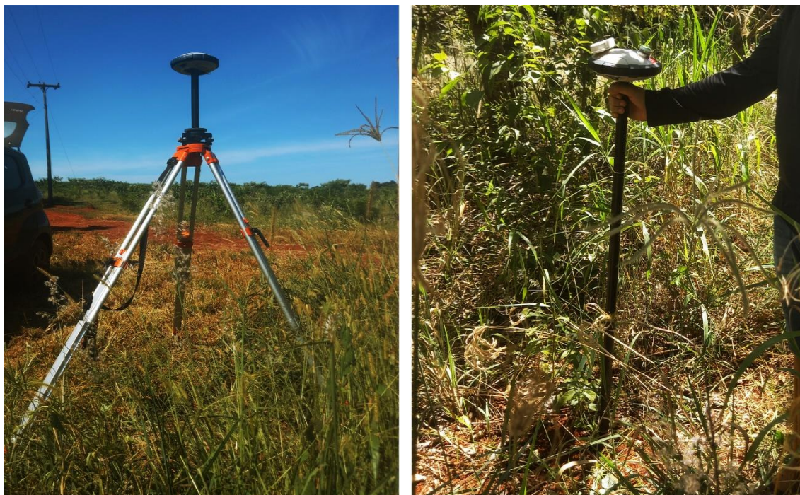
Figura 10. GPS RTK ( Real-time Kinematic ) utilizado para a coleta de dados de localização com alta precisão, no plantio sombreado.
