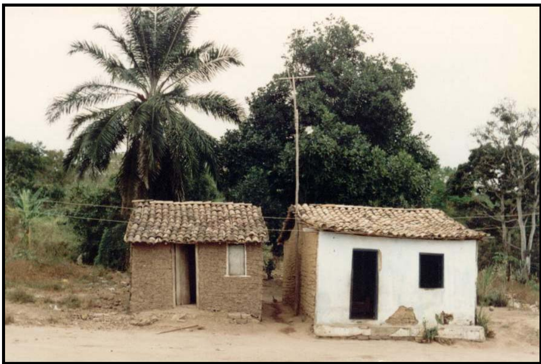
Figura 21 - Casa de taipa sem reboco. Matéria-prima: troncos, cipós e argila.
