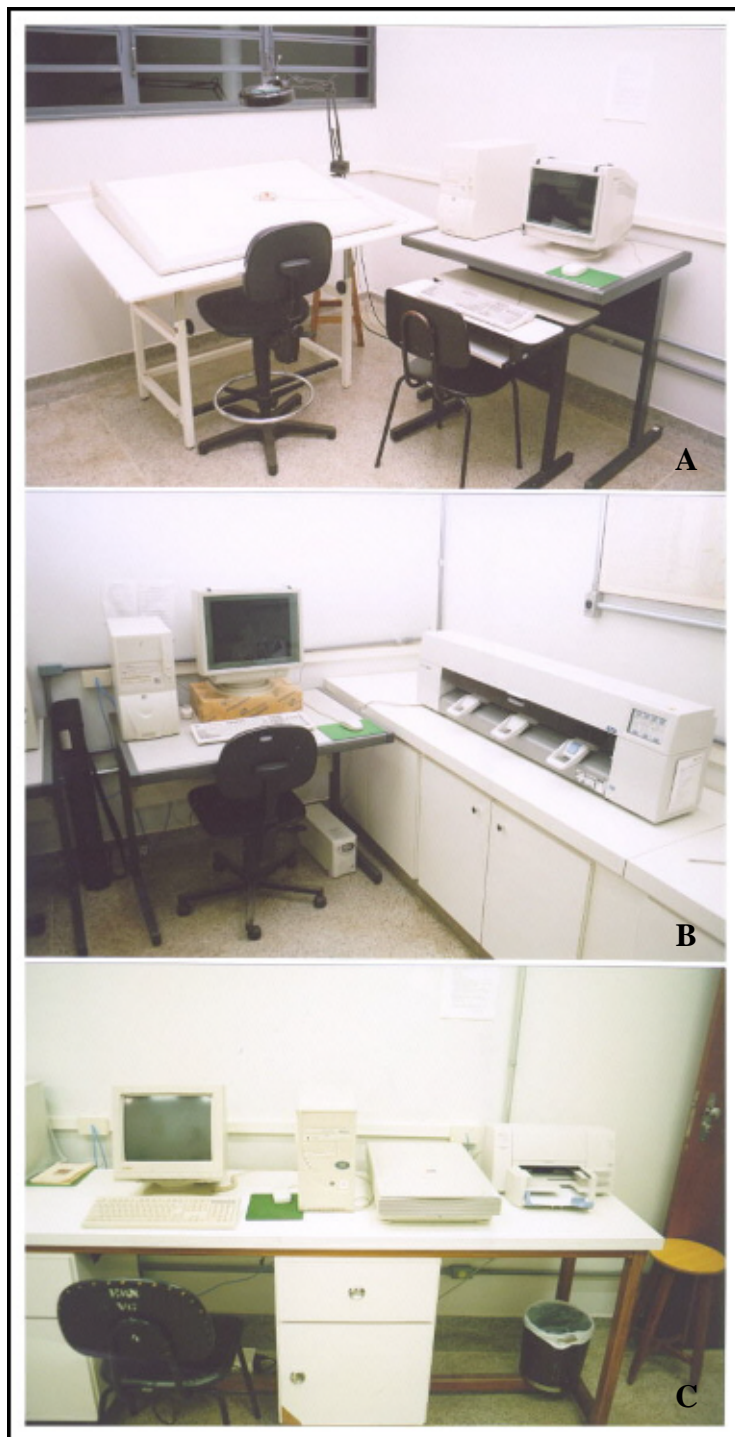
FIGURA 6 - Fotografias dos equipamentos utilizados para o tratamento digital das informações. A-Mesa digitalizadora acoplada ao microcomputador, B-Plotter e microcomputador e C-
