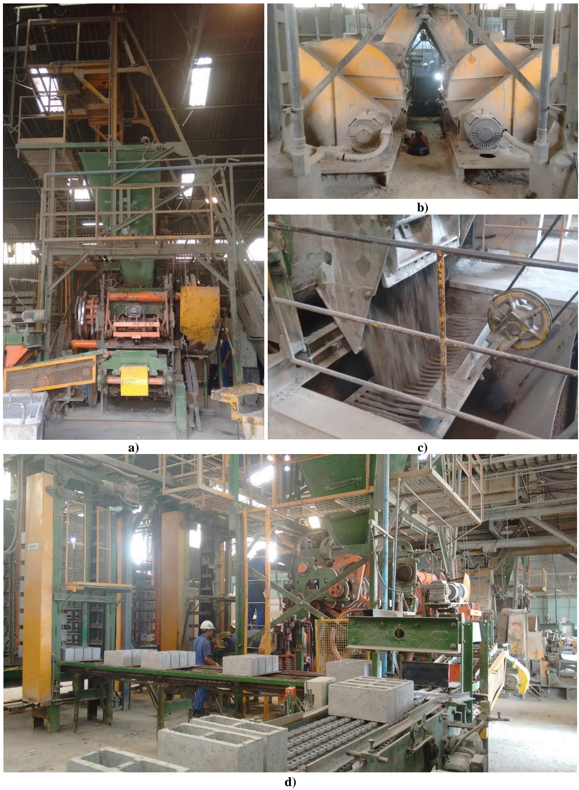
Figura 3.21 – Vibroprensa utilizada na produção dos blocos: a) máquina visão frontal; b) misturadores; c) preenchimento do carrinho; d) saída dos blocos moldados.
