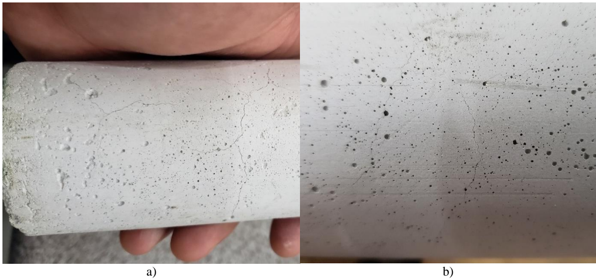
Figura 4.4 – Fissuração das argamassas convencionais após 800°C: a) AC10; b) AC20.
