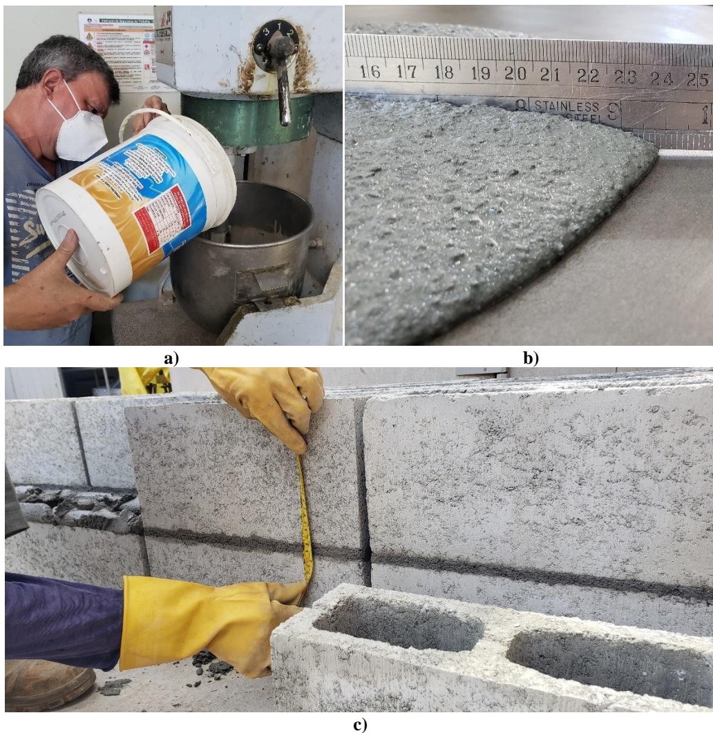
Figura 3.39 – Assentamento dos prismas com blocos de concreto: a) mistura das argamassas; b) determinação da consistência; c) conferência espessura de junta; d) conferência de prumo; e) pano úmido sobre argamassa; f) prismas moldados.
