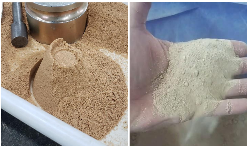
Figura 3.12 – Areia média: a) no estado saturado superfície seca; b) após secagem em estufa.
