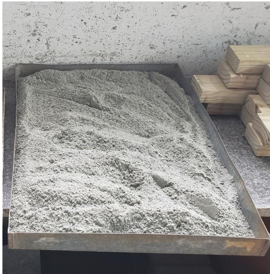
Figura 3.6 – Caracterização dos agregados utilizados na fabricação dos blocos de concreto: a) disposição em badeiras metálicas; b) secagem em estufa a 110°C; c) quartejamento Pó de pedra A; d) quartejamento pedrisco dos blocos.
