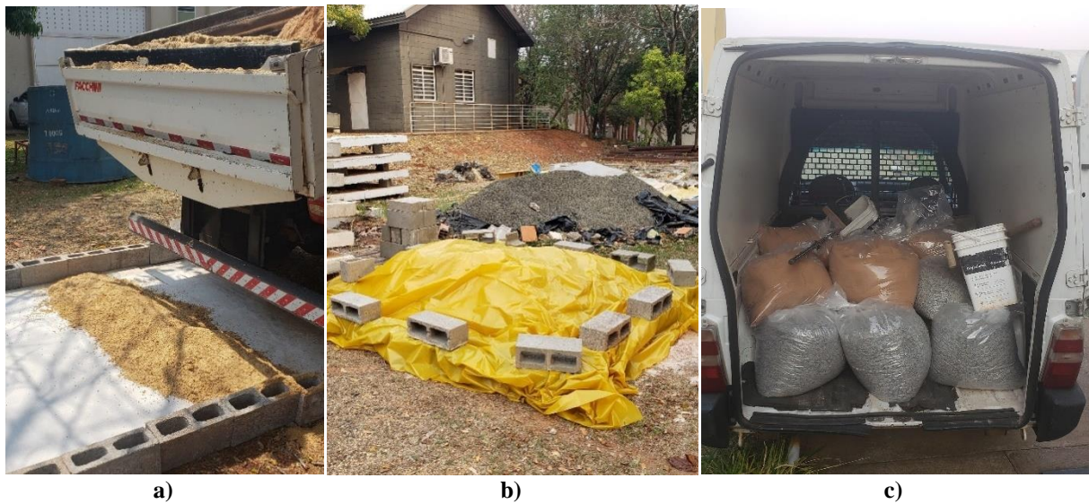
Figura 3.8 – Caracterização dos agregados utilizados na produção dos grautes e argamassas de assentamento: a) disposição sobre placas de fibrocimento; b) proteção com lona plástica; c) preparo para transporte até São Carlos-SP.
