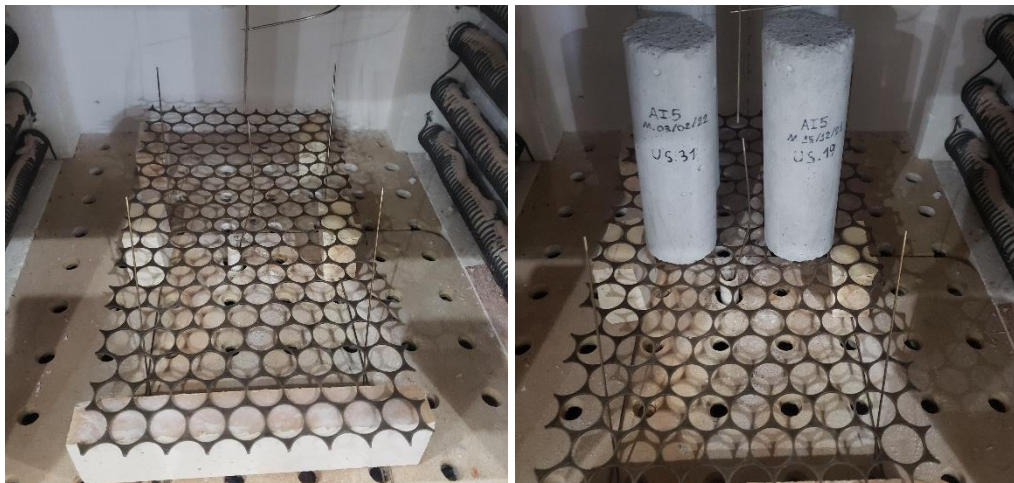
Figura 3.44 – Queima das argamassas: a) posicionamento dos termopares e corpos de prova; b) corpos de prova antes da queima; c) perda da identificação visual com a queima; d) pesagem após resfriamento; e) aquisição.
