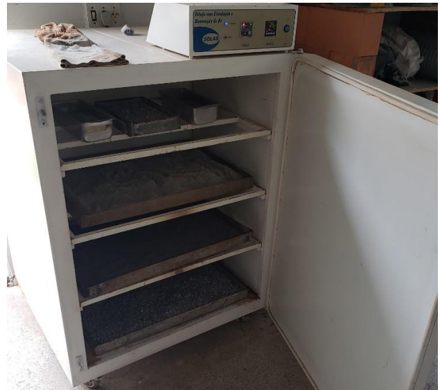
Figura 3.6 – Caracterização dos agregados utilizados na fabricação dos blocos de concreto: a) disposição em badeiras metálicas; b) secagem em estufa a 110°C; c) quartejamento Pó de pedra A; d) quartejamento pedrisco dos blocos.
