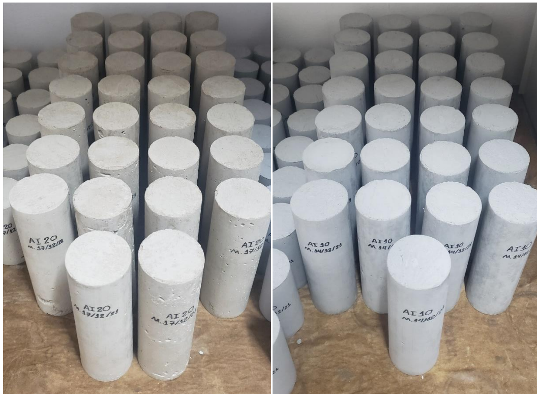
Figura 3.37 – Moldagens corpos de prova cilíndricos 1:3 para ensaios de altas temperaturas: a) corpos de prova de argamassas durante cura; b) adensamento de grautes em mesa vibratória; c) moldes de graute vedados com plástico filme; d) cura dos corpos de prova de graute dentro do laboratório.
