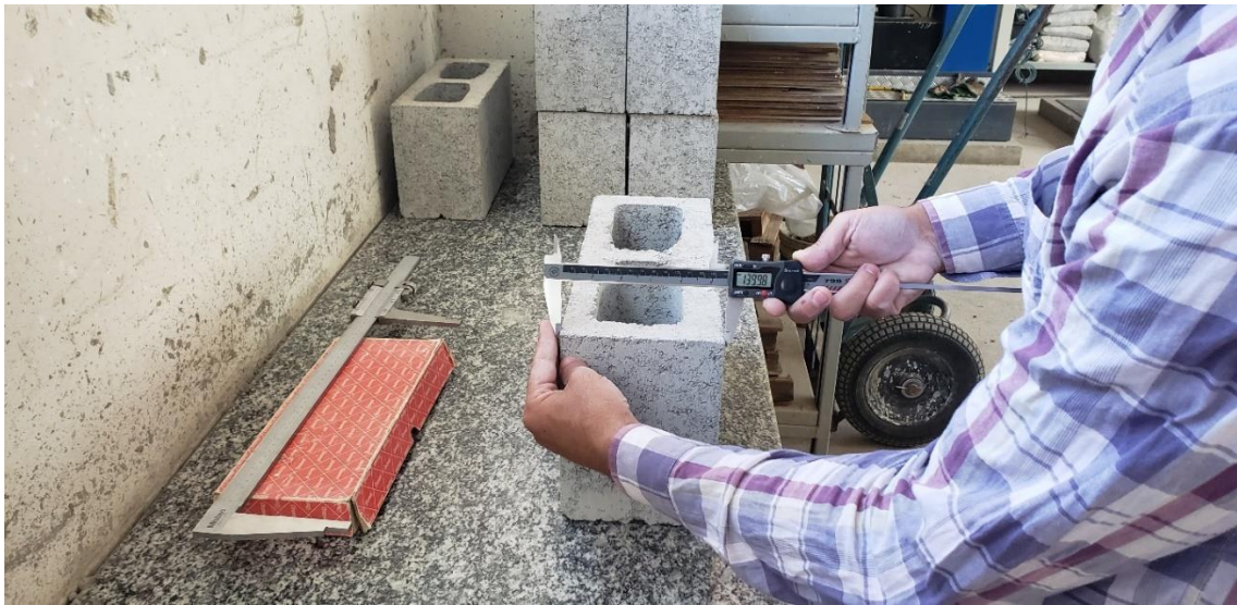
Figura 3.23 – Análise dimensional dos blocos: a) largura em bloco 6 MPa; altura em bloco 12 MPa; comprimento em bloco 24 MPa .
