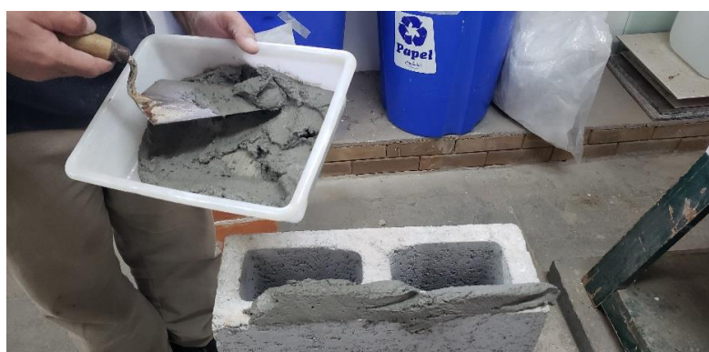
Figura 3.13 – Teste de aplicação de argamassa durante os ensaios de consistência no LMC da UFSCar.
