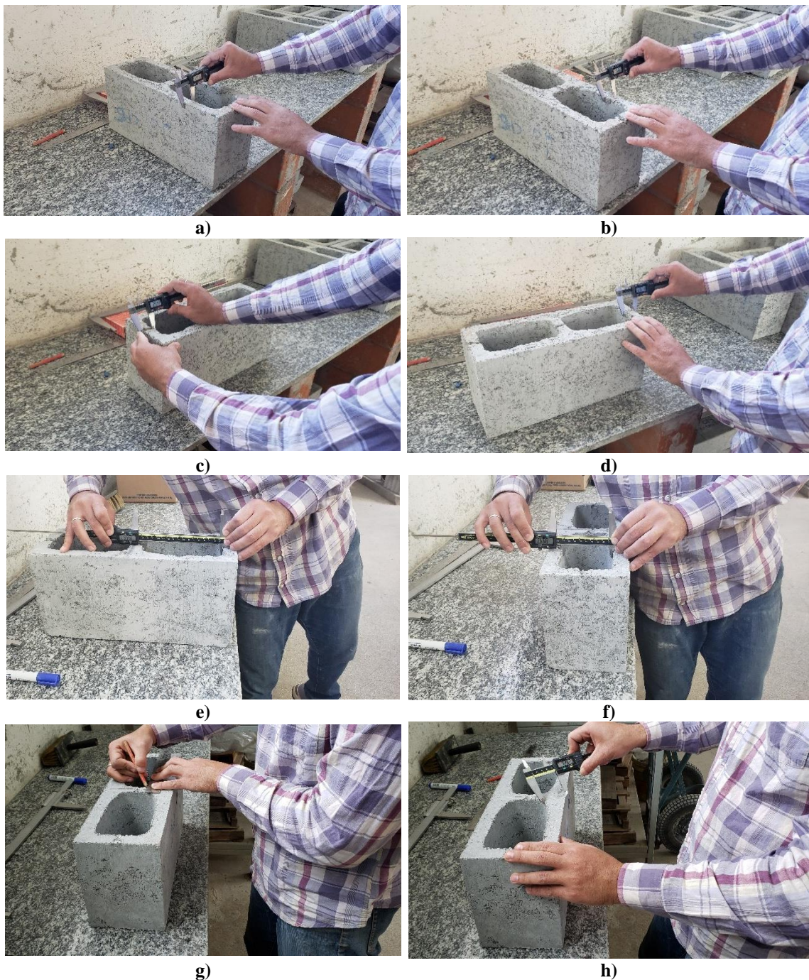
Figura 3.24 – Análise dimensional dos blocos: a) espessura parede longitudinal A; b) espessura parede longitudinal B; c) espessura parede transversal borda A; d) espessura parede transversal central; e) comprimento do furo; f) largura do furo; g) marcação; h) raio de mísulas.
