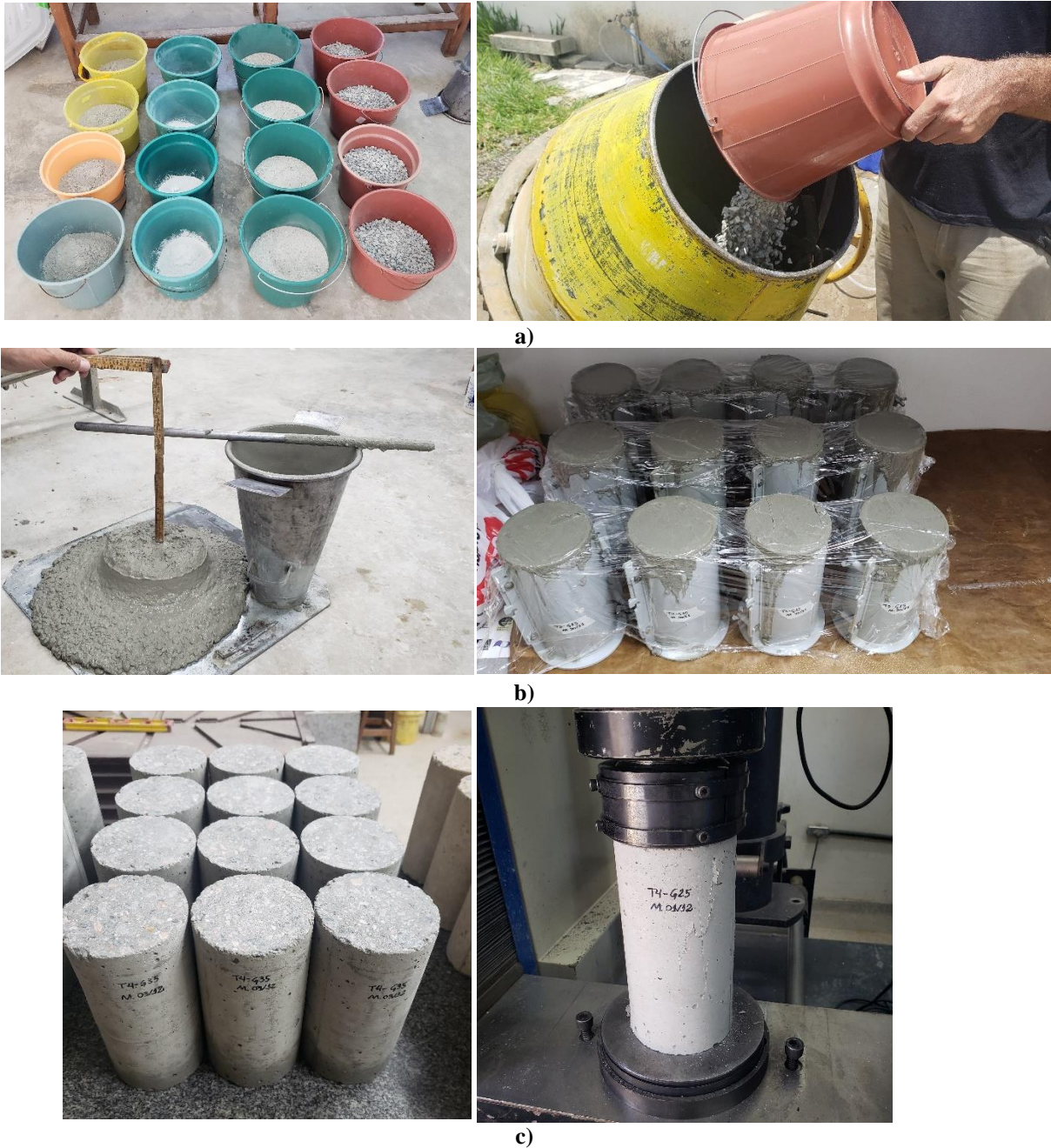
Figura 3.20 – Ensaio no estado fresco e endurecido para testes de grautes com a areia branca: a) materiais pesados e mistura; b) abatimento no estado fresco e corpos de prova recém moldados; b) corpos de prova cilíndricos cilindro Ø100 x 200 mm após a retífica e ruptura.
