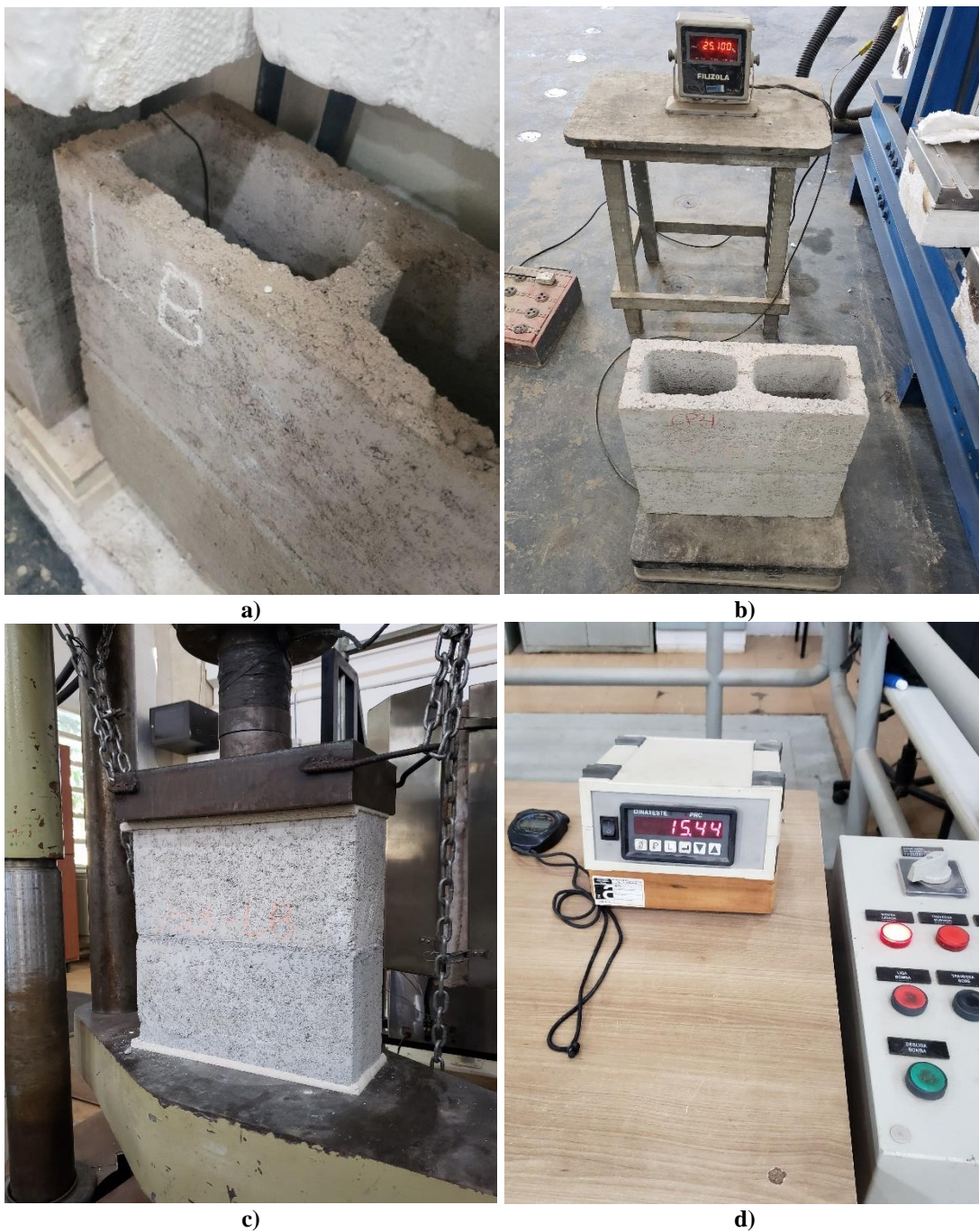
Figura 3.48 – Determinação das propriedades residuais em prismas: a) prisma após queima de 600°C; b) pesagem pós queima; c) resistência à compressão; d) registro da força em toneladas pela prensa; e) módulo de deformação; f) prisma rompido.
