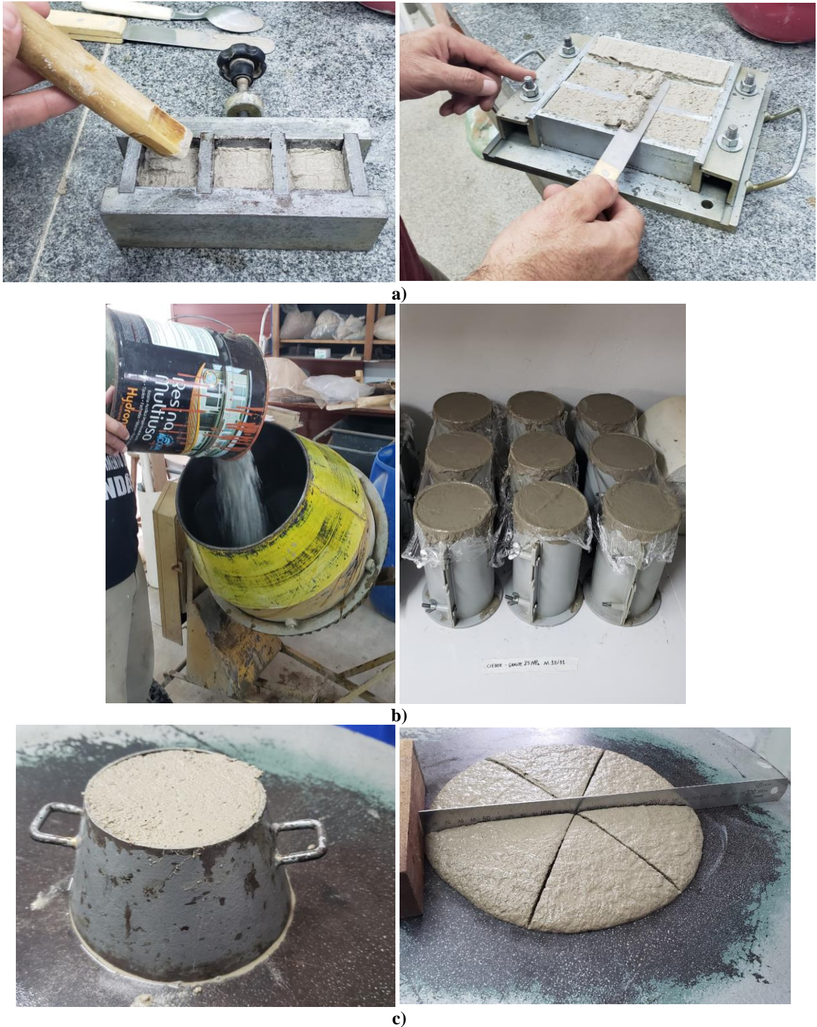
Figura 3.14 – Moldagem e ensaios no estado fresco de argamassas e grautes para teste de agregados: a) moldagem argamassa; b) moldagem graute; c) ensaios no estado fresco argamassa - índice de consistência; d) ensaio no estado fresco graute – abatimento.
