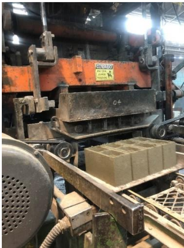
Figura 2.18 – Fabricação de blocos vazados de concreto pelo processo de vibrocompressão.
