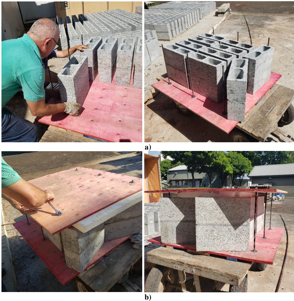
Figura 3.42 – Dispositivo para transporte dos prismas: a) inserção dos prismas; b) travamento.
