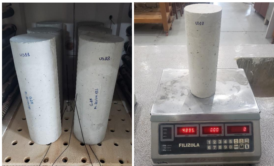
Figura 3.45 – Queima dos grautes e prismas: a) corpos de prova de graute no forno mufla; b) pesagem graute pós queima; c) prismas inseridos no forno; c) termopares nos furos dos blocos; e) aquisição.
