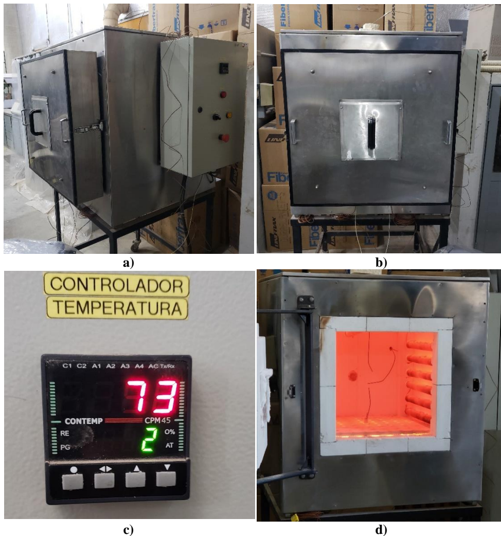
Figura 3.40 – Forno mufla empregado nas queimas de argamassas e grautes: a) visão frontal do forno; b) controlador digital; c) interior do forno em temperatura ambiente; d) resistências aquecidas.
