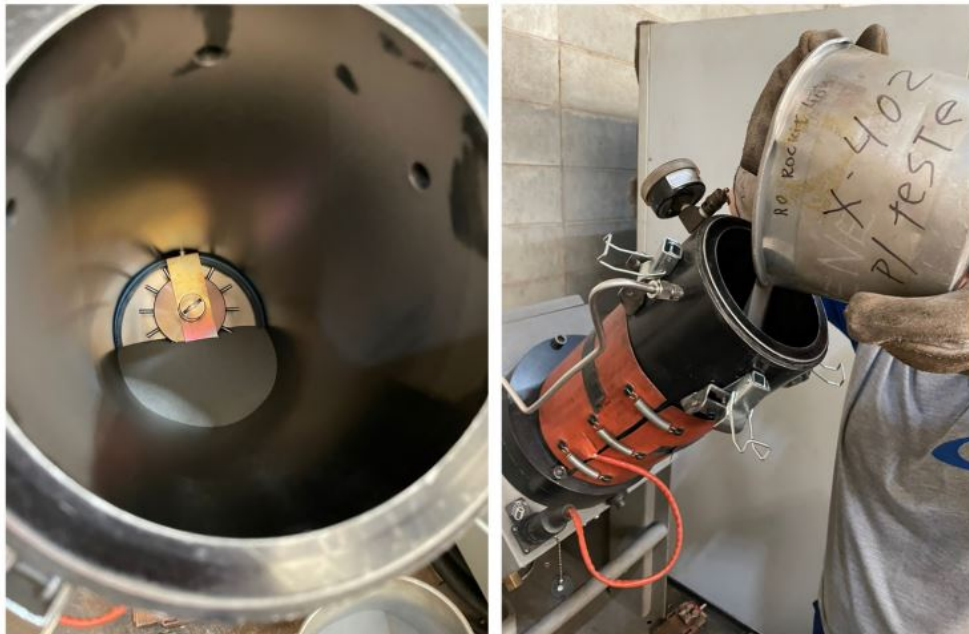
Figura 32 – Tambor de abastecimento de pó metálico para cabeçote de LC.
