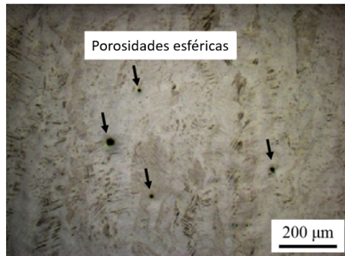
Figura 10 – Presença de poros em revestimento de selective laser melting .
