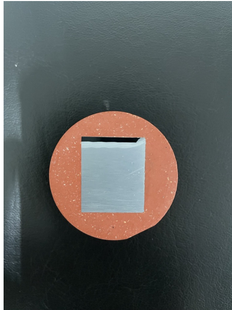
Figura 42 – Aspecto dos corpos de prova após ataque com Nital 3%.
