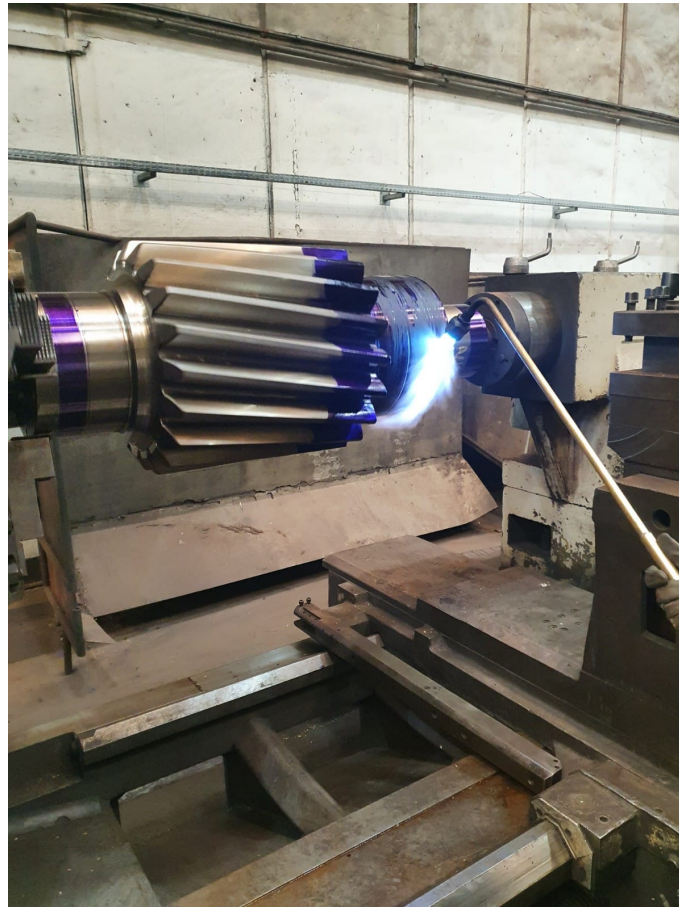
Figura 23 – Pré-aquecimento do pinhão com maçarico.
