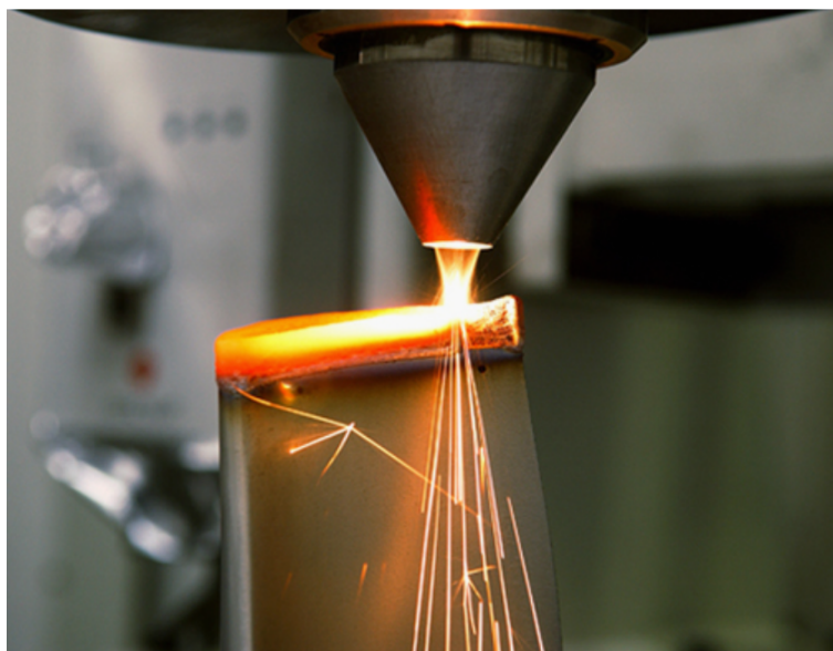
Figura 7 – Reparo de palheta de turbina a gás por LC.
