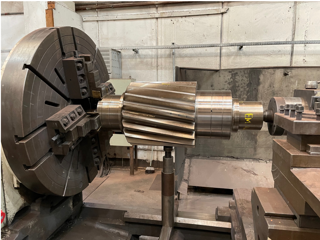
Figura 22 – Eixo pinhão montado no torno Clever L-76320.
