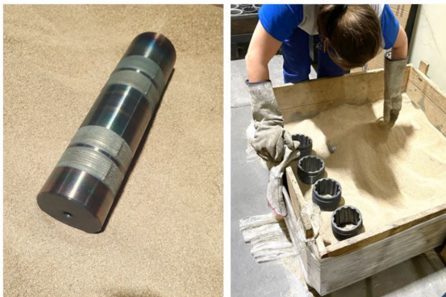
Figura 37 – Caixa com vermiculita para resfriamento lento de peças após revestimento.
