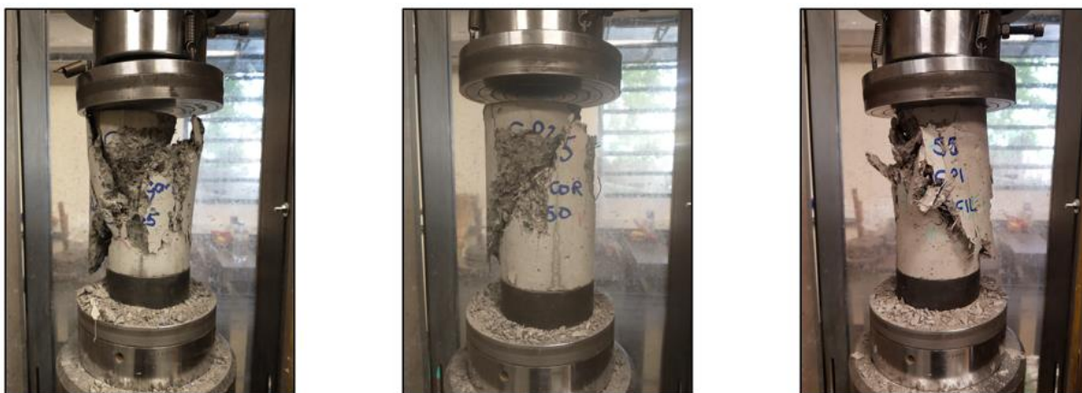
Figura 90. Modos de falha observados nos ensaios de compressão em conformidade com a ABNT NBR 5739 (2018).
