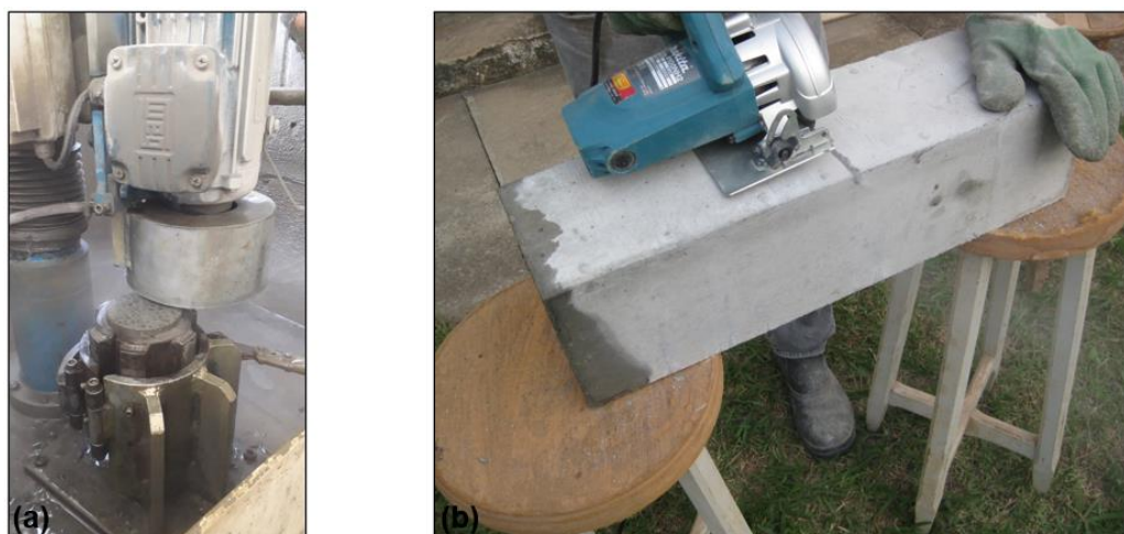
Figura 76. Preparação dos corpos de prova para ensaio: (a) retífica dos corpos de prova cilíndricos e (b) entalhe nos prismas.
