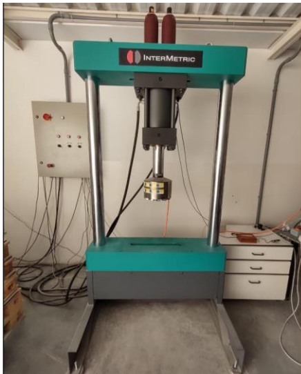
Figura 126. Máquina InterMetric utilizada nos ensaios de flexão em três pontos.
