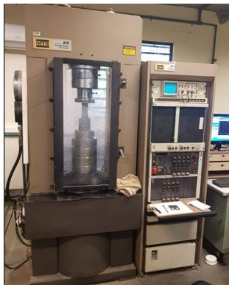
Figura 84. Máquina MTS815 utilizada nos ensaios de compressão.
