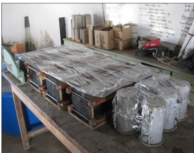
Figura 74. Corpos de prova cobertos com plástico para evitar perda de água por evaporação.
