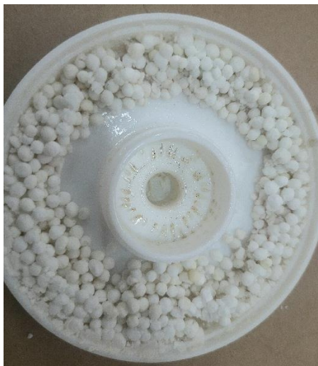
Figura 25 - Aspecto visual dos pellets no RPB após a reação com óleo vegetal.
