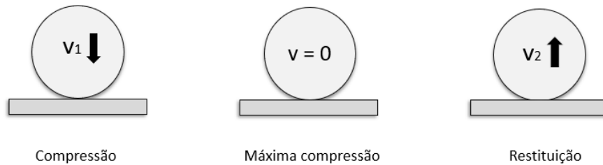
Figura 2 - Etapas de compressão e restituição em uma colisão.
