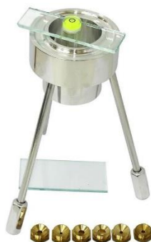
Figura 29 - Viscosímetro copo Ford (modelo 010574 da marca Techvision )
