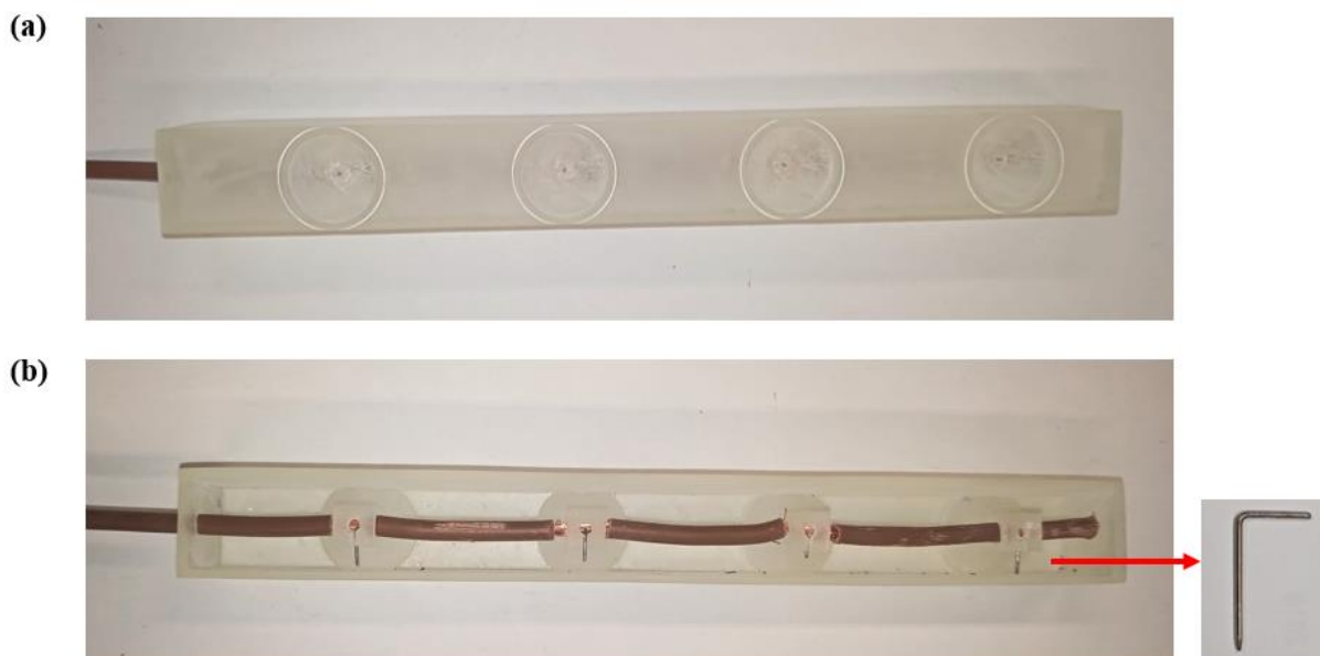
Figura 44 - Peça suporte para os eletrodos de descarga: (a) vista frontal e (b) vista traseira (com os eletrodos).
