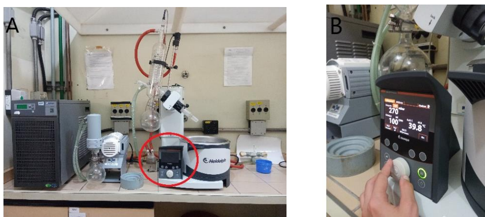
Figura 3: Rotaevaporador (Heidolph G3). A) Da esquerda para a direita: medidor de temperatura, bomba a vácuo para auxiliar na evaporação e regulador de velocidade e de vácuo (destacado em vermelho – B ). Foto: arquivo pessoal.
