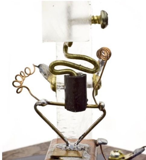
Figura 6: Réplica do primeiro transistor desenvolvido em 1947
