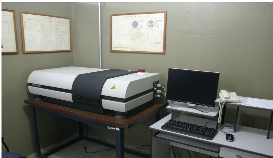
Figura 4.4: Foto do equipamento microtomógrafo de raios-X Sky Scan 1172
