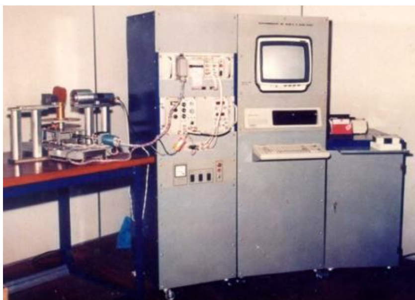
Figura 1.1. Minitomógrafo de mesa (Cruvinel, 1987). Retirada de (Cnpdia-Embrapa, 2011).
