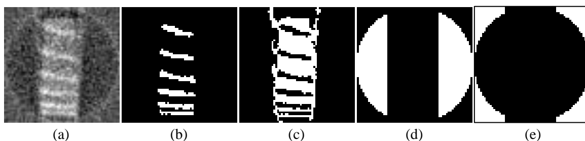
Figura B.10. Áreas homogêneas selecionadas para Madeira 2 reconstruída por FBP: (a) imagem ruidosa, (b) regiões de estruturas claras, (c) parte escura do objeto, (d) parte escura do suporte e (e) fora do suporte.
