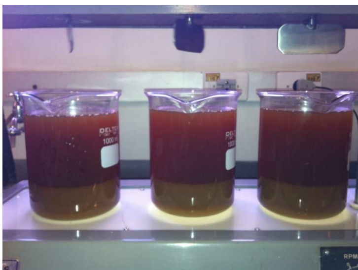
Figura 5.16: Triplicatas de vinhaça decantada em Jar-test após adição de \text{Al}_2(\text{SO}_4)_3 e pH ajustado para 12,9 com NaOH.
