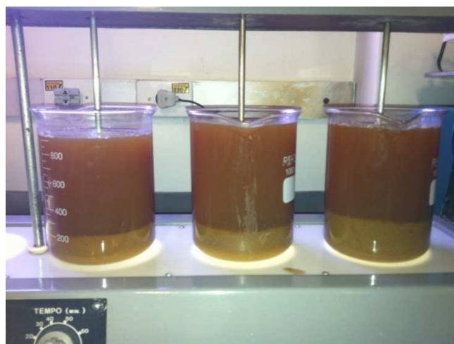
Figura 5.15: Triplicatas de vinhaça após decantação em Jar-test utilizando \text{Ca(OH)}_2 p.a. como coagulante
