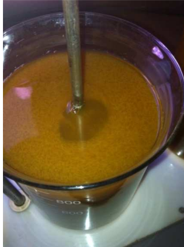
Figura 5.14: Aspecto da amostra de vinhaça e colóide floculado com cal extinta
