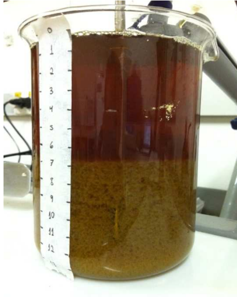
Figura 5.21: Aspecto visual da amostra de vinhaça decantada com \text{Al}_2(\text{SO}_4)_3 após adição de ácido fosfórico
