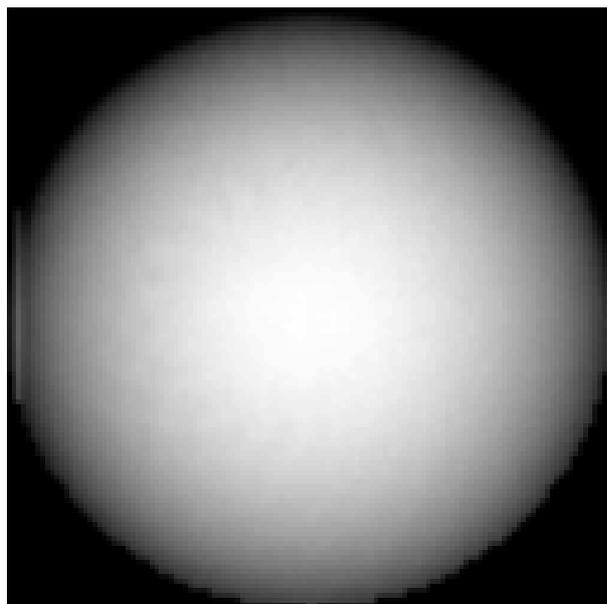
**FIGURA 3.10** – Phantom homogêneo de nylon reconstruído por retroprojeção filtrada.
