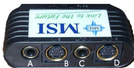
Figura 5.4: Adaptador que realiza a conversão de interfaces DVI-I para RCA.
