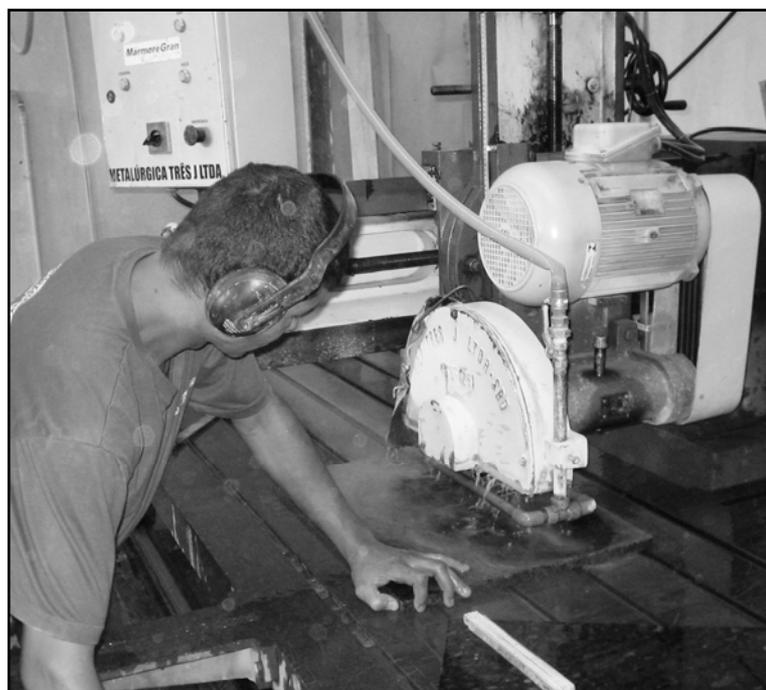
**Figura 46 – São Paulo (Estado). Município de São Carlos. Serragem de peça de granito. Note-se o risco de contato da mão do trabalhador com a lâmina da serra**
