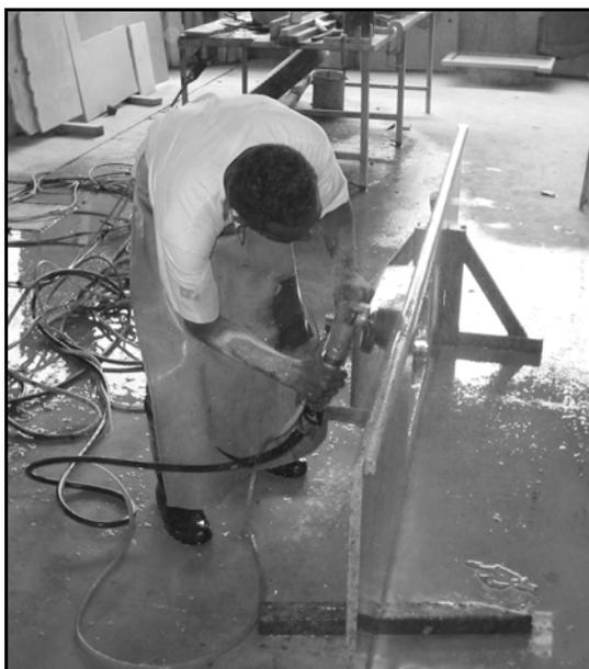
**Figura 60** – São Paulo (Estado). Município de Rio Claro. Postura curvada devido ao desajuste entre a altura do cavalete e a altura do trabalhador.
