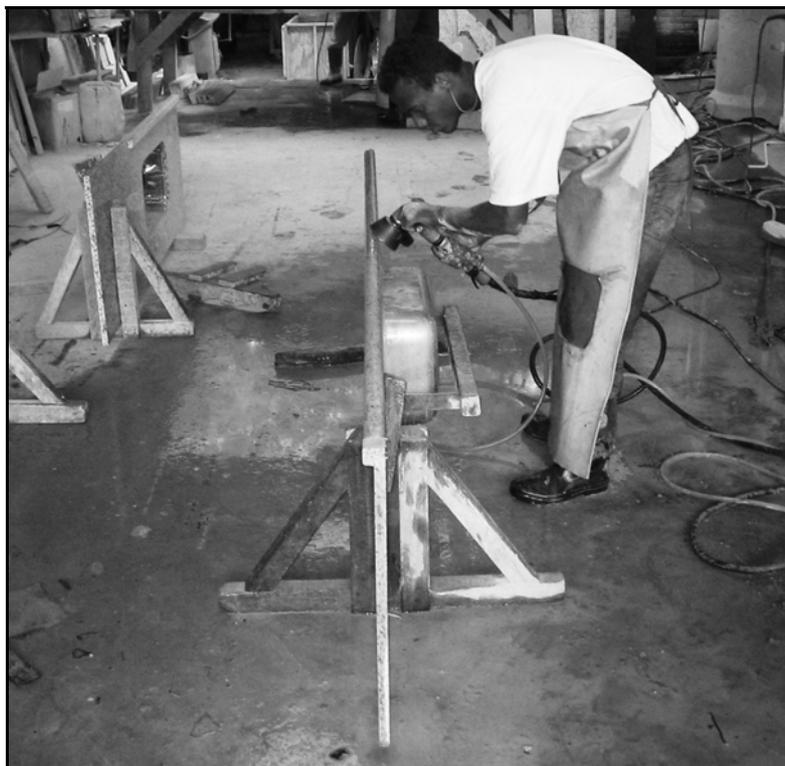
**Figura 51 – São Paulo (Estado). Município de Rio Claro. Cavalete de madeira utilizado para o lixamento a úmido. Note-se o desajuste entre a altura do cavalete e a altura do trabalhador.**
