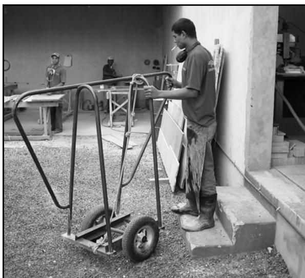
**Figura 56 – São Paulo (Estado). Município de São Carlos. Degraus utilizados para a transposição de um posto de trabalho para outro, dificultando a movimentação de objetos e instrumentos de trabalho.**
