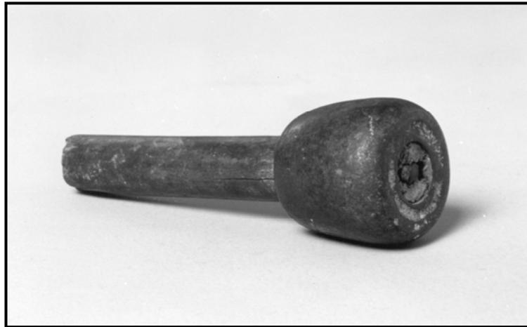
**Figura 6 – Maceta: martelo utilizado para o desbaste inicial da rocha**
