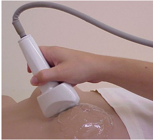
FIGURA 4.6 – Mock-up 01 (carenagem do transdutor) sendo utilizado na simulação das operações rotacionais na atividade de ultra-sonografia.
