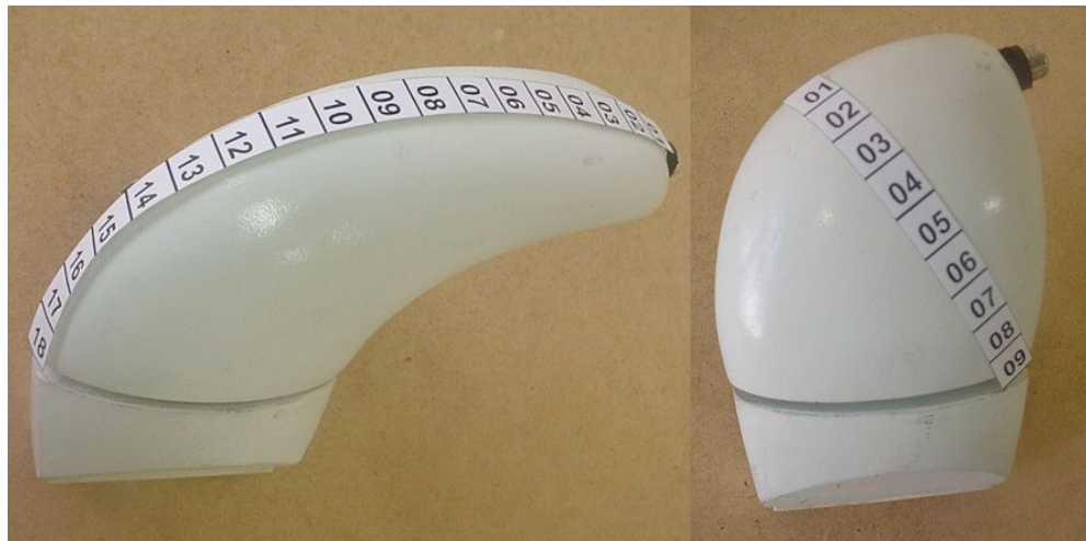
FIGURA 3.31 – Peças finais do Mock-up 02 e 03, com dimensões baseadas nas especificações dos dados antropométricos da mão humana.
