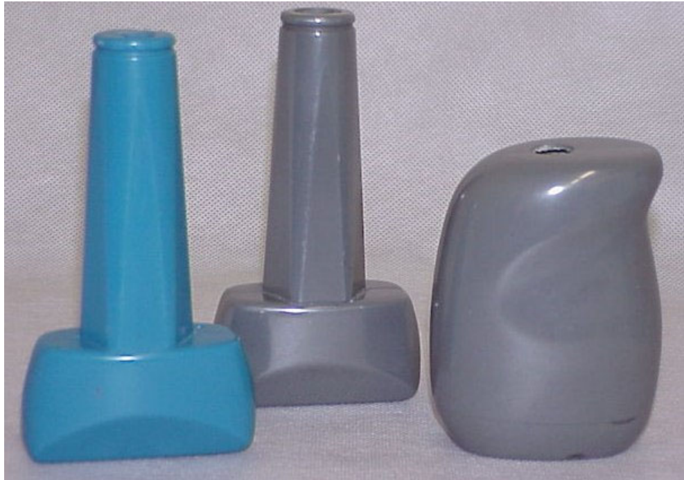
FIGURA 3.18 – Peças finais do Mock-up 01, modeladas em PRFV (azul) e PRFC (grafite).
