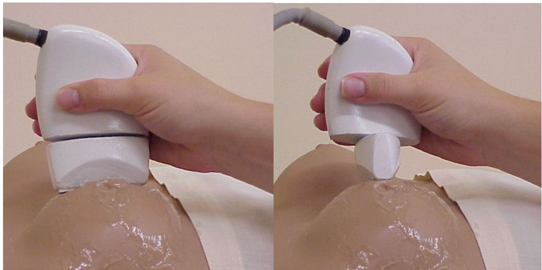
FIGURA 4.16 – Modelo tridimensional do Mock-up 03, durante simulação das operações transversais (direita) e longitudinais (esquerda) da atividade de ultrassonografia.
