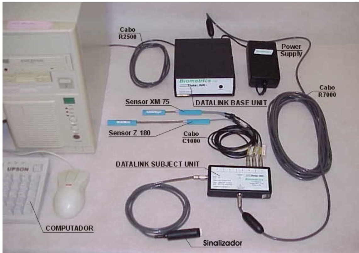
FIGURA 3.4 – Esquema de conexão entre os vários elementos do DataLINK para a primeira experimentação.
