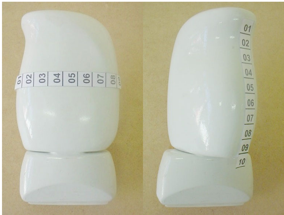
FIGURA 3.19 – Peças finais do Mock-up 01 com dimensões baseadas nas especificações dos dados antropométricos da mão humana.
