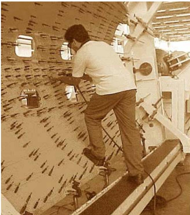
Figura 4.11 - Geometria da peça determinando o espaço de trabalho.
