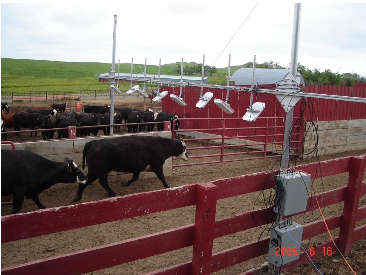
Figura 10: Projeto de portal - uso de oito antenas e dois leitores em propriedades de gado de corte.
