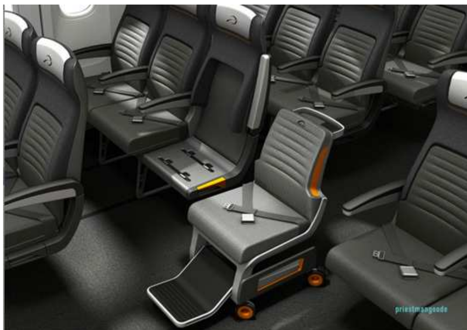
Figura 14 – Conceito de cadeira de rodas de bordo, desenvolvida pela Priestmangoode
