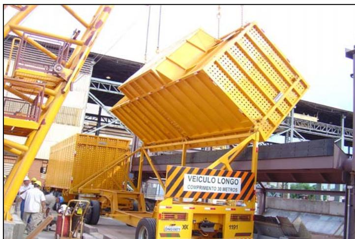
**FIGURA 4.5 – Descarga de caminhão de cana picada de bscula superior**
