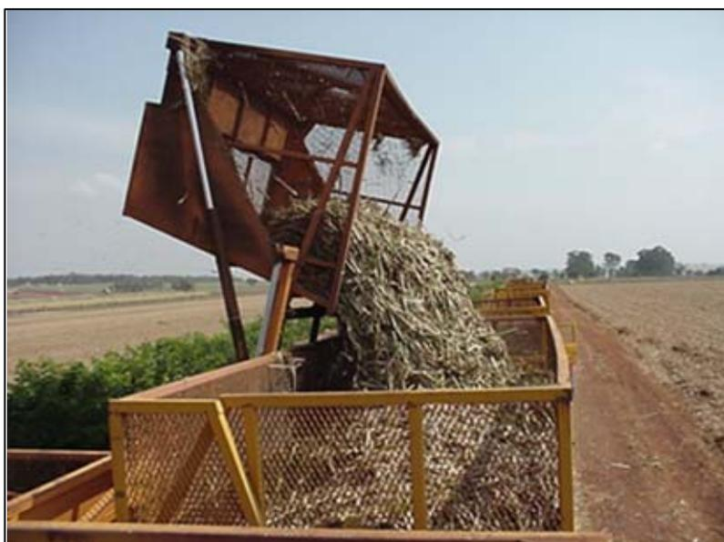
**FIGURA 5.7: Transferência de carga para o “treminhão” de cana picada**
