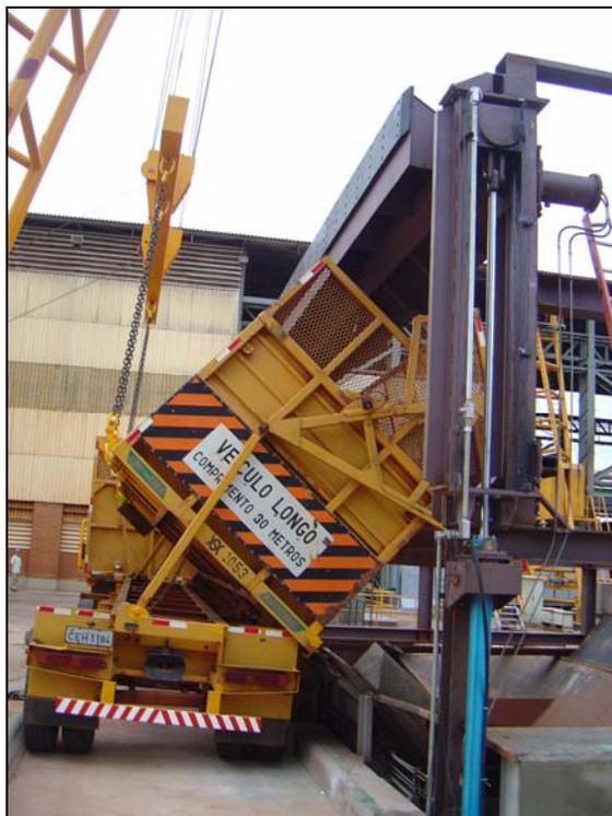
**FIGURA 4.4 – Descarga de caminhão de cana picada de báscula lateral**
