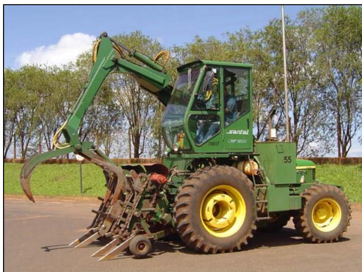
**FIGURA 5.2 - Carregadora de cana-de-açúcar**
