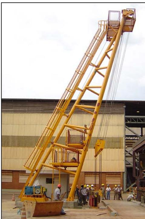
**FIGURA 4.3 – Hilo para a descarga de caminhões**
