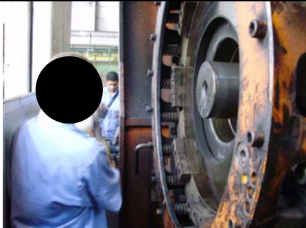
Foto 1: Profissional soltando parafusos de fixação da carcaça da embreagem
