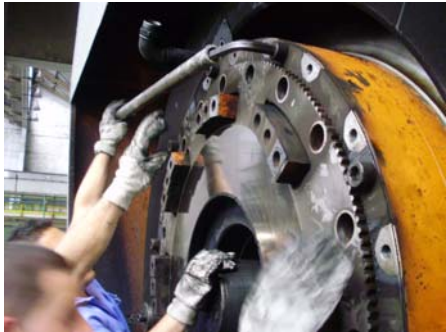
Foto 4: Profissionais soltando parafusos parte superior do êmbolo
