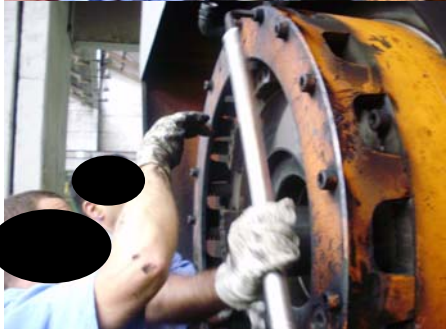
Foto 2: Profissionais soltando parafusos da parte superior (possibilidade da chave soltar)
