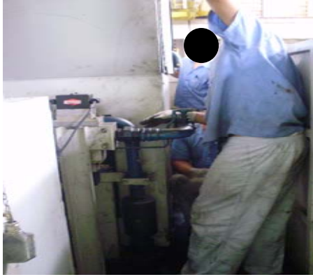
Foto 4: Profissionais soltando os parafusos inferiores da proteção de acesso à embreagem.
