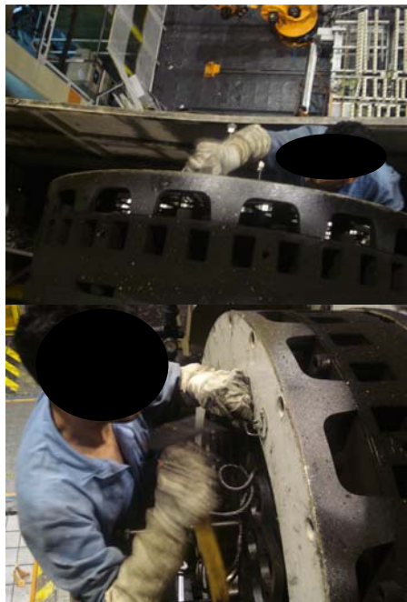
Foto 4: Profissional desmontando dispositivo de verificação da folga do freio
