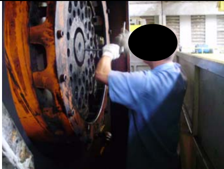
Foto 1: Profissional soltando parafusos do anel expansivo traseiro.
