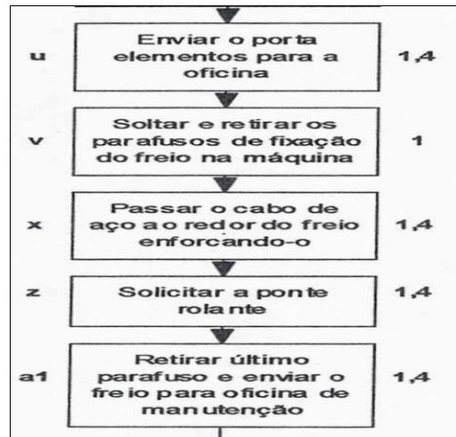
Figura 4.13 – Sequência de desmontagem do freio (ITI)
