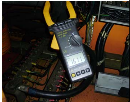
Foto 4: eletricitista medindo a corrente de armadura
