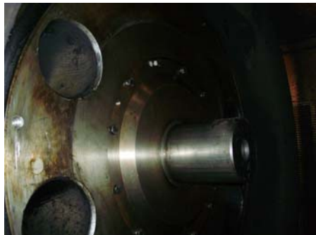
Foto 4: Rôscas avariadas e eixo com rebarbas
