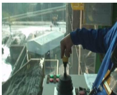
Figura 4-36: Comando “homem morto” do manete.
