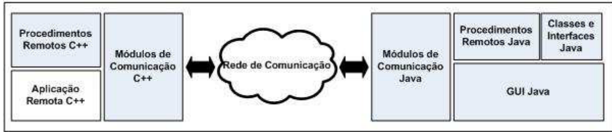
Figura 3.12: Códigos Gerados pelo Gerador de GUI com Suporte a RT-RPC.
