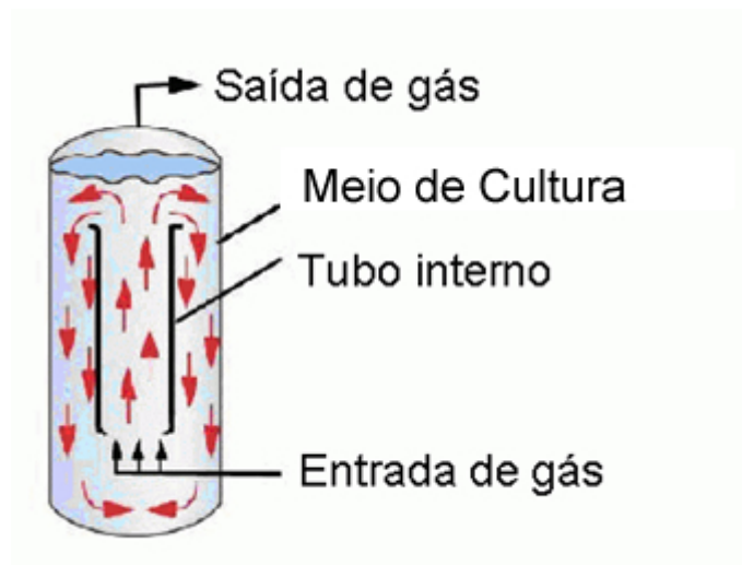
Figura 2-4. Desenho esquemático do biorreator airlift de cilindros concêntricos.
