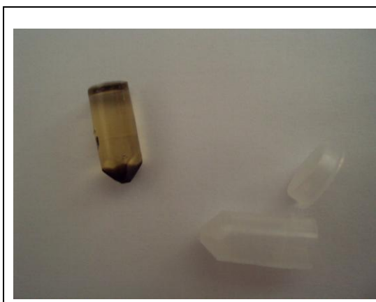
Figura 3.5. Cápsula Bin e catalisador fixado em resina.
