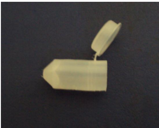
Figura 3.4. Cápsula Bin (molde de plástico) para a fixação do catalisador na resina.
