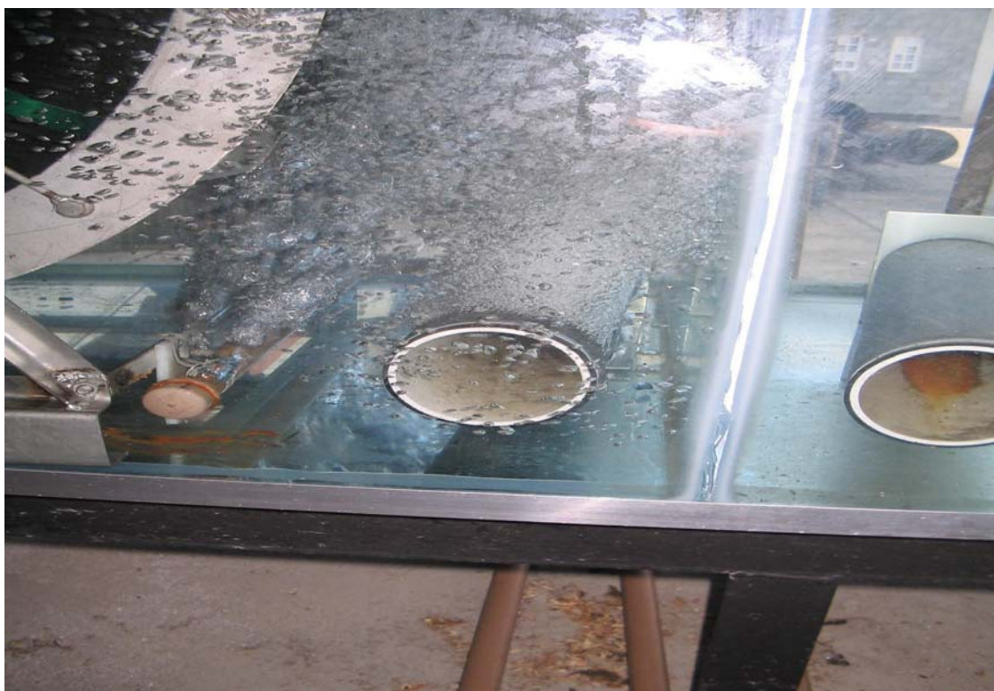
Figura 4.8: Detalhe do sistema de aeração via difusor tubular de bolha fina
