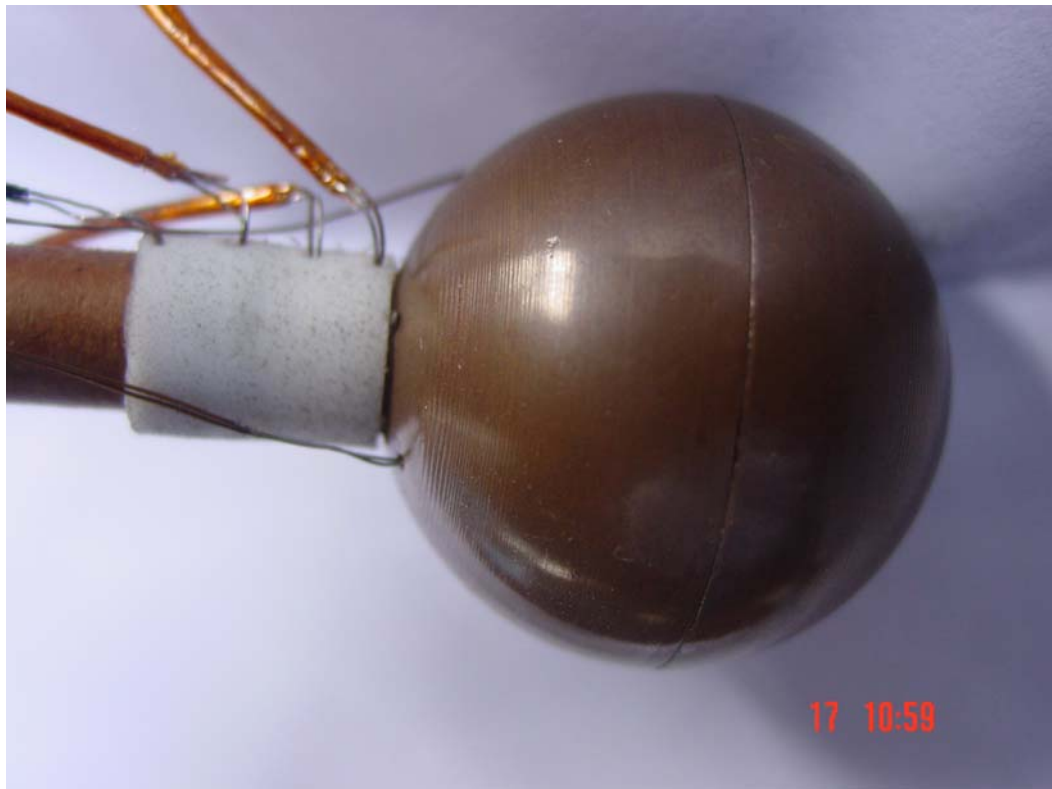
Figura 3.9 – Foto mostrando a esfera com o teflon e os termopares
