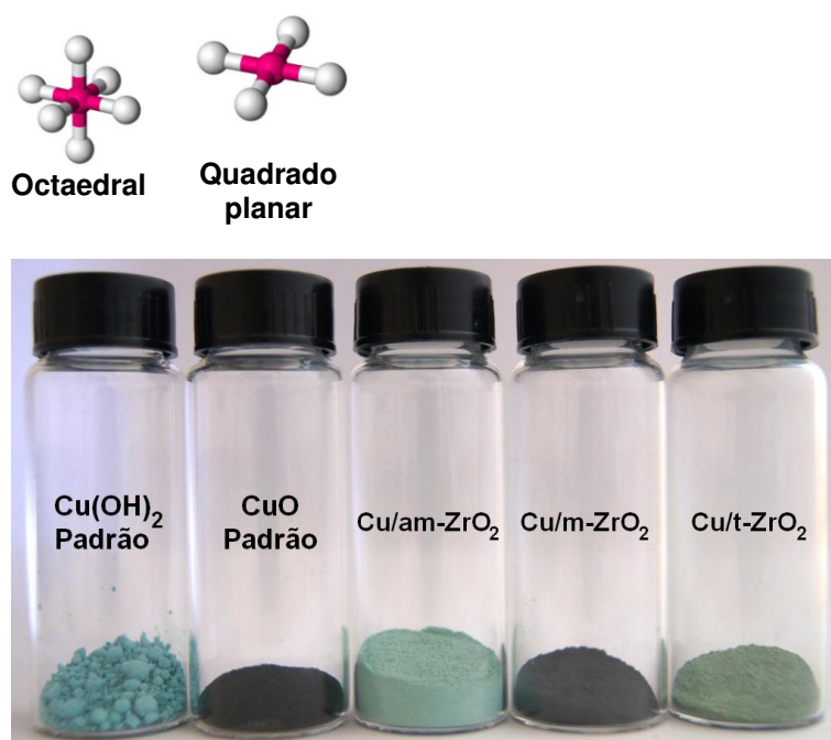
Figura 4. 21 – Cores dos padrões de CuO e Cu(OH) 2 e respectivas coordenações geométricas ao lado das amostras frescas calcinadas de Cu/ZrO 2 .
