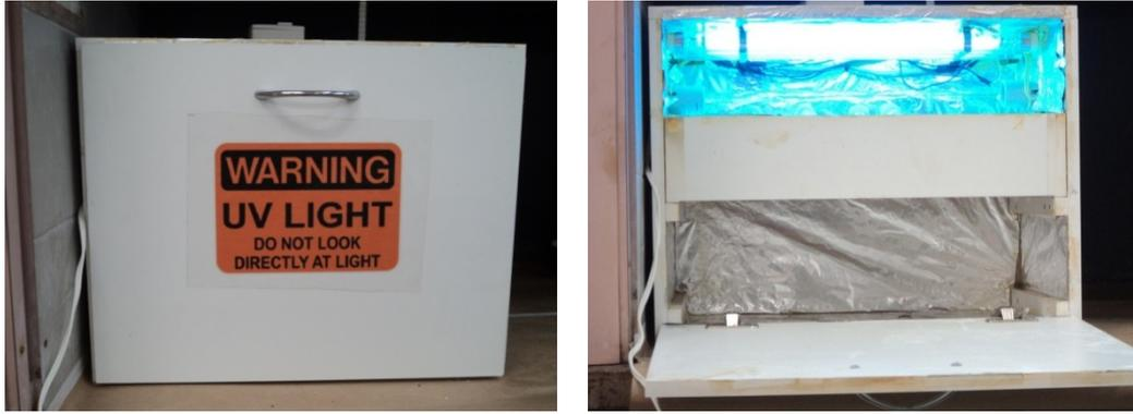
Figura 4.5: Aparato para polimerização utilizando lâmpadas ultravioletas UVC.
