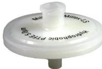
Figura 4.11: Imagem do filtro Millex (0,45 µm)
