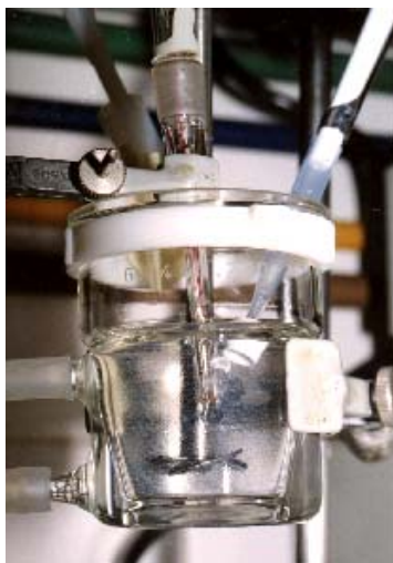
Figura 3.7: Detalhe da síntese no momento da retirada de amostra com filtro na ponta da pipeta. 75
