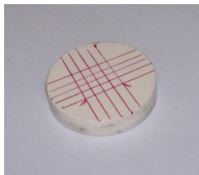
Figura 3.11 – Substrato comprimido de celulose microcristalina marcado em quadrantes.
