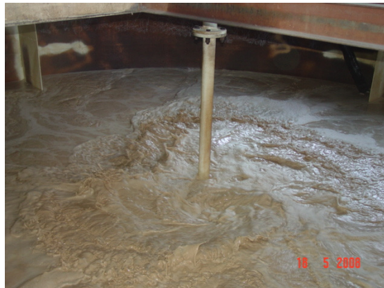
Figura 2.7. Foto do tratamento do fermento em uma das cubas de uma unidade industrial no Estado de São Paulo.
