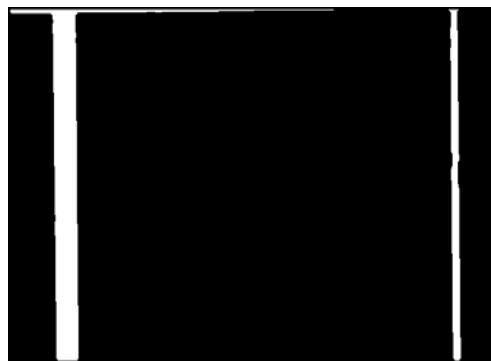
Figura 5.41: Imagem binária da amostra de células S2 após realização de thresholding (com valores para a identificação da região de interesse das linhas presentes na imagem adquirida), abertura e fechamento.
